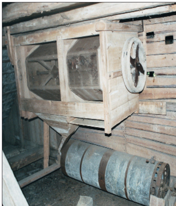
Obr. 7. Mlýn Bělá čp. 1 (CR). Čistící hranolový vysévač s trieurem – koukolníkem z r. 1897. Foto D. Veverka, 2011.
