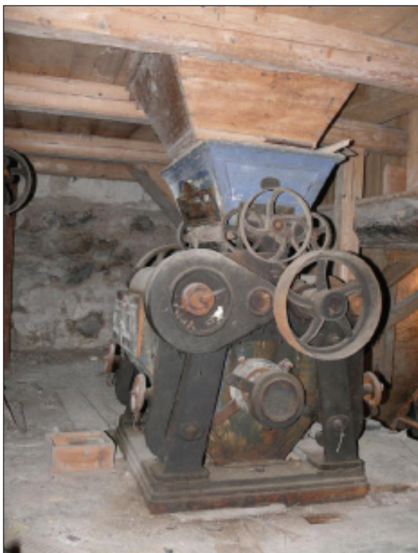
Obr. 7. Pustověty čp. 7 (RA). Interiér mlýnice, válcová stolice Ganz. Foto I. Minář, 2011.
