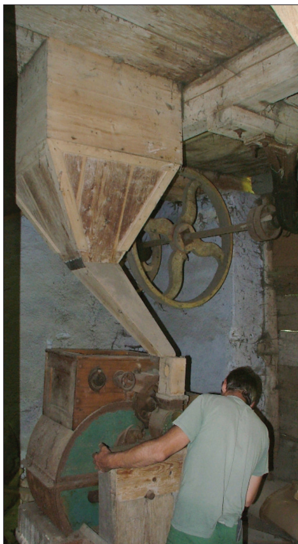
Obr. 2. Hamry čp. 45 (CR). Periodická loupačka na mlecí podlaze. Foto T. Ledvinka, 2007.
