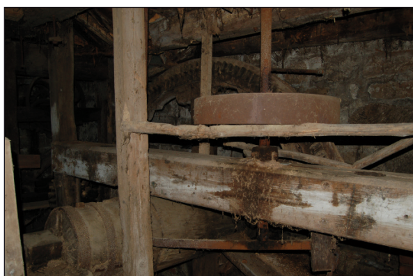
Obr. 13. Turnov, mlýn č. p. 374 (SM), pohled na tradiční dřevěnou hřídel, paleční kolo a mladší typ železí, podpíraný trámem – kobylicí (celý nosný systém kobylice je druhotně vložený do starší mlýnské hranice cca v poslední čtvrtině 19. stol.), foto M. Kolka, 2011.
