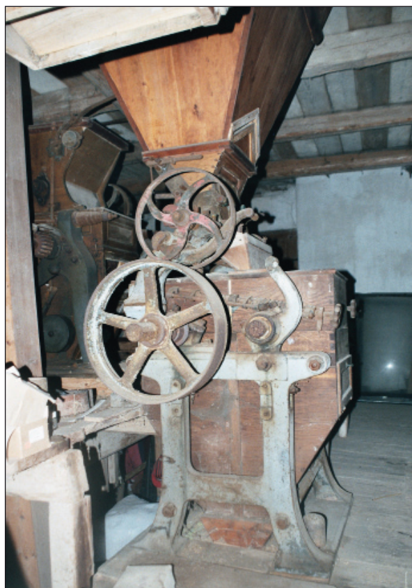
Obr. 14. Mlýn čp. 8 v Javorníčku, (UO). Válcová stolice s porcelánovými válci k tzv. luštění krupic. Fa. Friedrich Wegmann Wien Comp., r. 1888. Foto D. Veverka, 2010.
