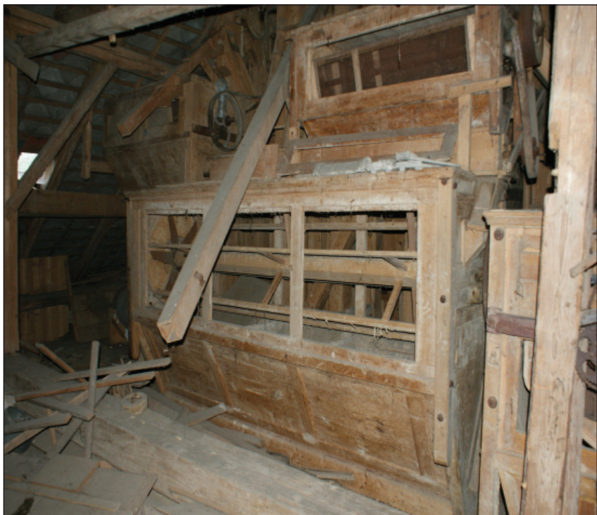
Obr. 22. Kunžak (JH) mlýn čp. 113. Moučný hranolový vysévač Jarosch Lhota u Nové Bystřice. Na něm je osazen předvysévač. Foto R. Urbánek, 2010.
