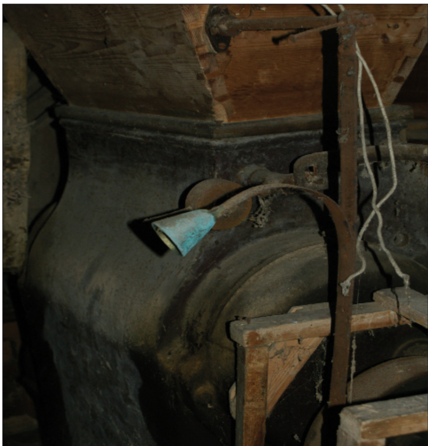
Obr. 21. Kunžak (JH) mlýn čp. 113. Válcová stolice Hübner&Opitz Pardubice v litinové skříni s jedním párem válců, opatřená na zadní straně signálním zvonkem. Foto R. Urbánek, 2010.
