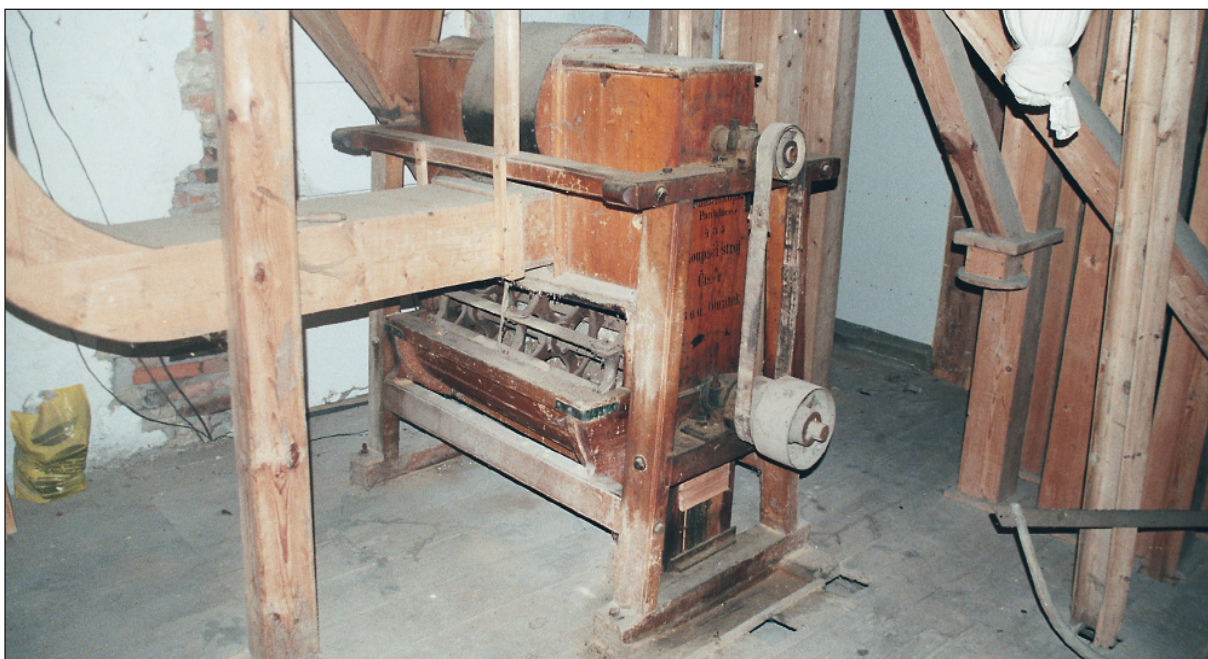
Obr. 17. Mlýn v Leštince čp. 4 (CR). Průchodová loupáčka fa. Hubner – Opitz z r. 1890. Foto D. Veverka, 2011.
