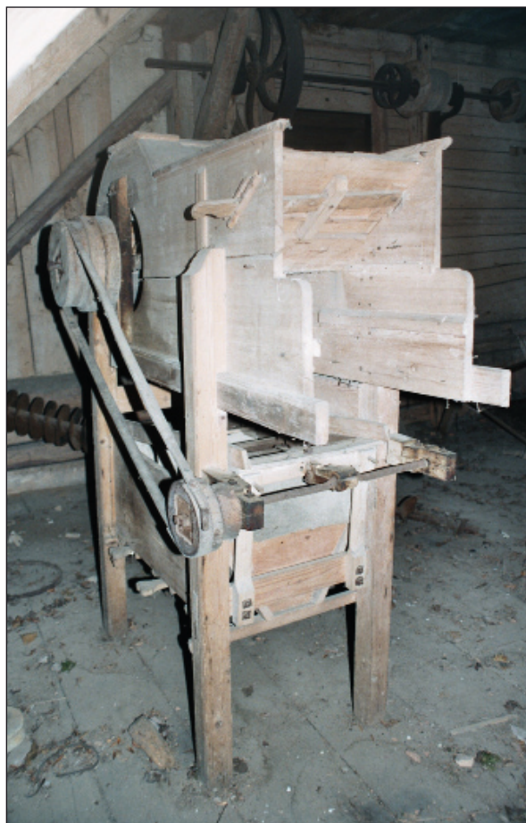
Obr. 6. Mlýn Bělá čp. 1 (CR). Tarár se žejbrem z r. 1897, výroba František Macák. Foto D. Veverka, 2011.
