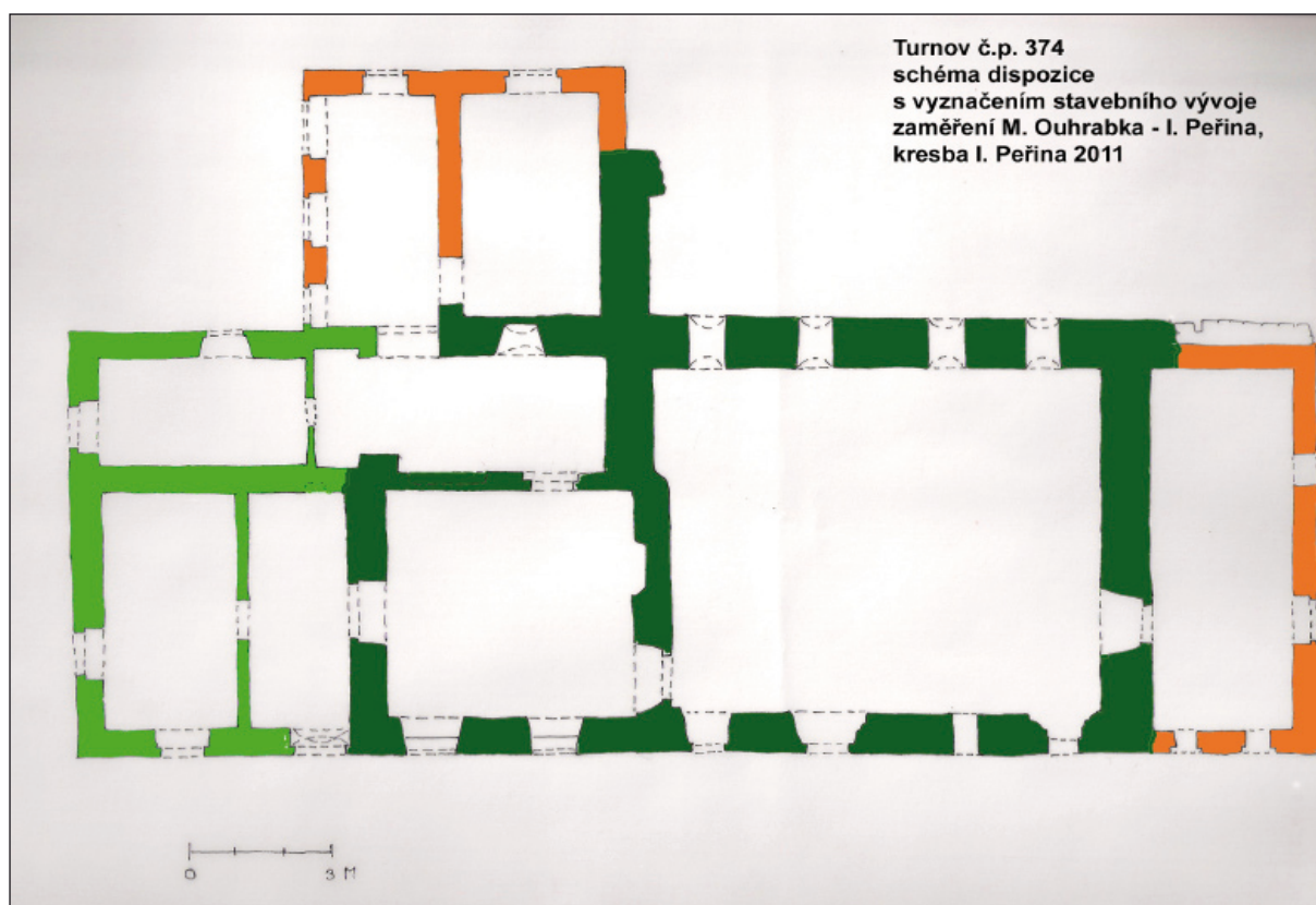
Obr. 3. Turnov, mlýn č. p. 374 (SM). Schéma dispozice přízemí s vyznačením stavebního vývoje, oba odstíny zelené barvy náleží klasicismu, oranžová barva 2. polovině 19. století. Zaměření M. Ouhrabka – I. Peřina, kresba I. Peřina, 2011.
