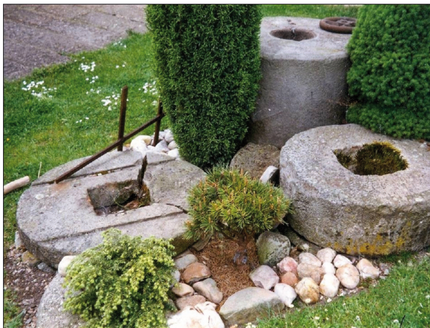
Obr. 17. Kozodry (RK). Pozůstatky mlecích kamenů u mlýna, moučné Ø 72 cm, spodek jahelky Ø 82 cm bez mlecí jílové vrstvy. Foto L. Štěpán, 2002.
