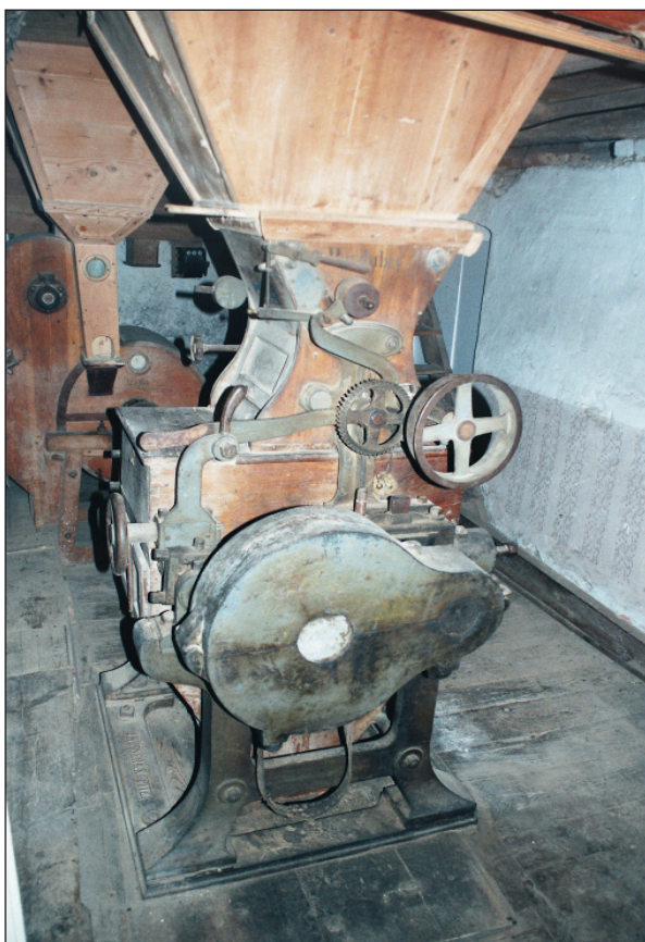
Obr. 13. Mlýn Světce čp. 13 (JH). Válcová mlecí stolice s rýhovanými válci s dřevěnou skříní, fa. Hubner Opitz z r. 1890. Foto D. Veverka, 2009.
