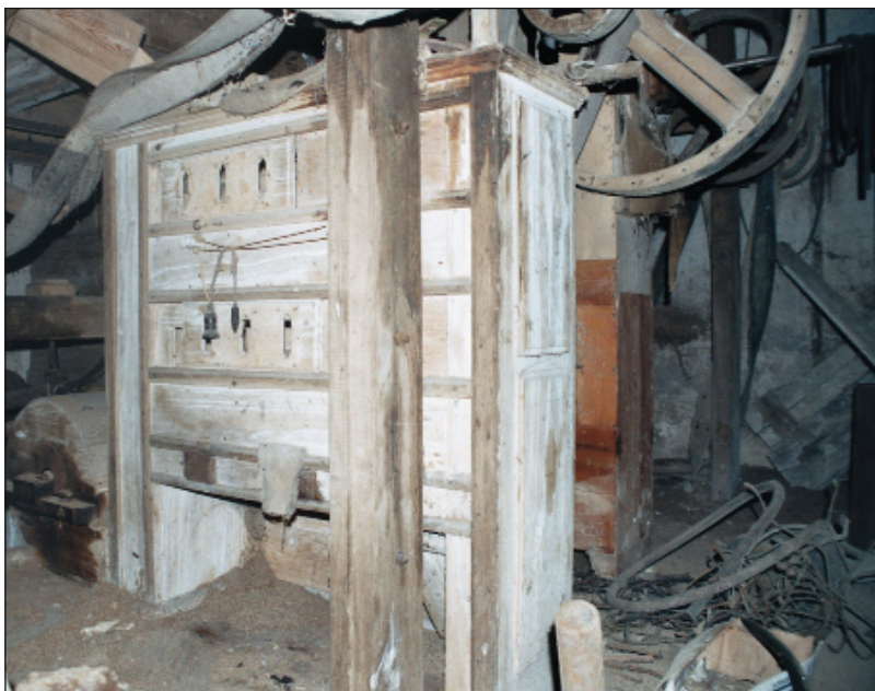
Obr. 10. Mlýn čp. 12 ve Svatém Mikuláši (UO). Jednoduchá štoska vyrobená kolem r. 1880. Foto D. Veverka, 2010.
