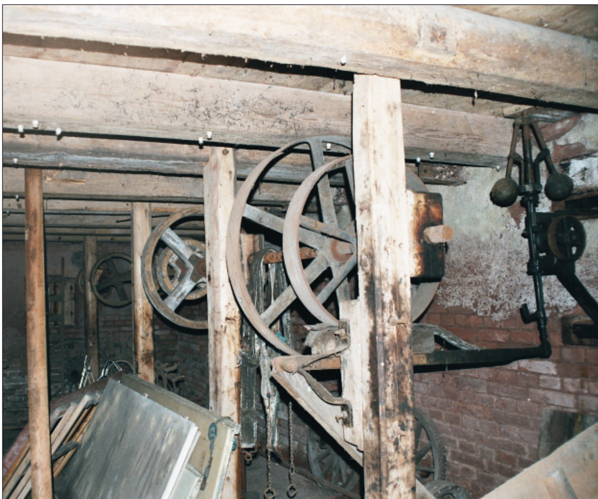
Obr. 4. Mlýn Kounov čp. 1 (RK). Transmise s brzdovou regulací pomocí Wattova kulového regulátoru. Foto D. Veverka, 2008.
