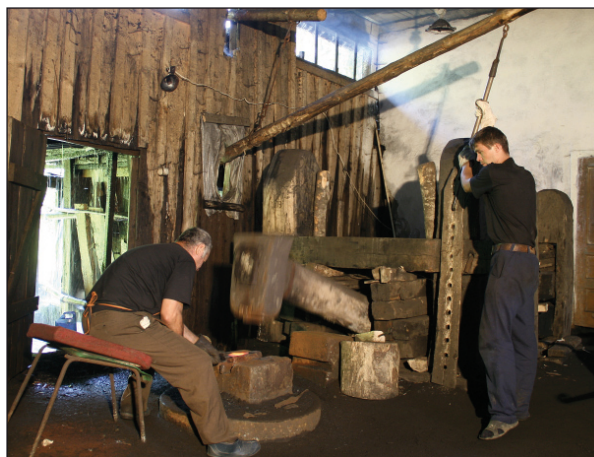
Obr. 15. Funkční hamr ve vsi Lysyčovo (Zakarpattí) slouží nejenom jako muzeální objekt, ale i jako vesnická kovárna. Foto O. Krushynska, 2011.
