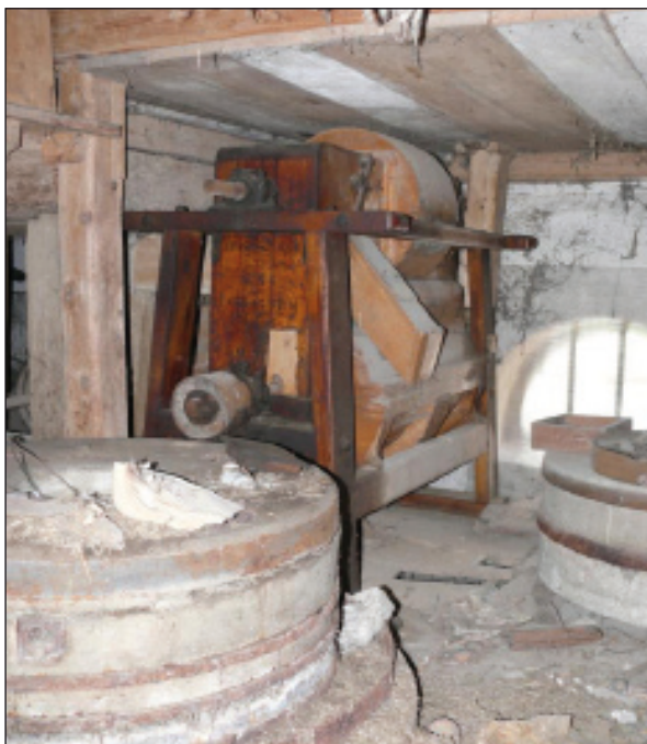
Obr. 5. Pustověty čp. 7 (RA). Interiér mlýnice, loupací stroj Hübner Opitz. Foto I. Minář, 2011.
