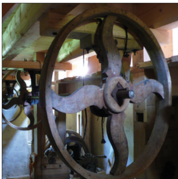
Obr. 15. Týniště čp. 28 (UL). Převody a hranice v podkolfi. Foto T. Ledvinka, 2011.
