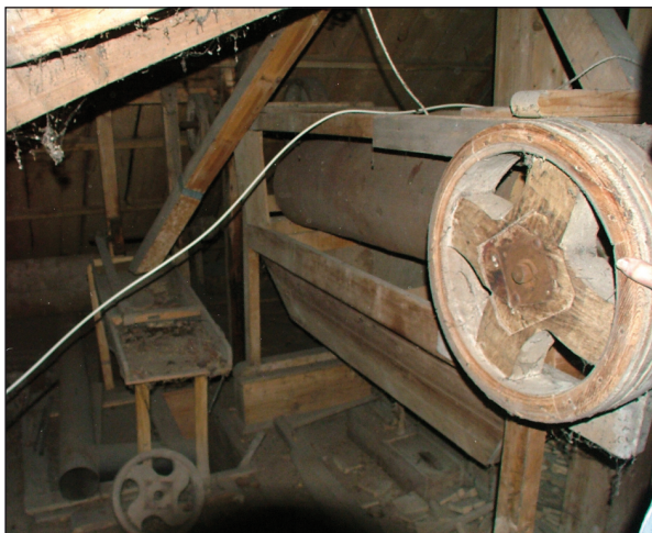
Obr. 3. Hamry čp. 45 (CR). Kláskové žejbro a stoklasový válec v podstřeší. Foto T. Ledvinka, 2007.
