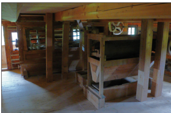
Obr. 18. Týniště čp. 28 (UL). Moučný hranolový vysévač a stoklasový válec na mlecí podlaze. Foto T. Ledvinka, 2011.
