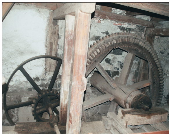
Obr. 3. Mlýn Leštinka čp. 4 (CR). Podkolí s čelním i bočním palečným kolem (unikát) k pohonu transmise a zároveň mlecího kamene. Foto D. Veverka, 2011.
