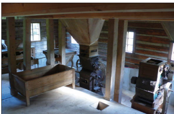
Obr. 16. Týniště čp. 28 (UL). Periodická loupáčka a válcová stolice na mlecí podlaze. Foto T. Ledvinka, 2011.
