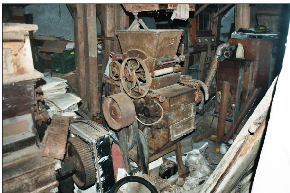
Obr. 15. Červený mlýn nedaleko Poteplí (KL). Stolice s porcelánovými válci čtyřválcová – tzv. tuplovka, fa. Friedrich Wegmann, r. 1885. Foto D. Veverka, 2008.
