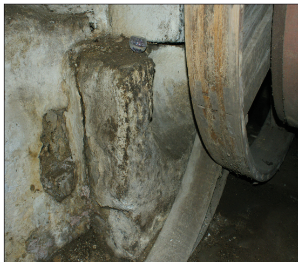
Obr. 19. Kunžak (JH) mlýn čp. 113. Rozpůlený kamenný štok ze stoupy pod kamenným sloupem mlýnské hranice. Foto R. Urbánek, 2010.
