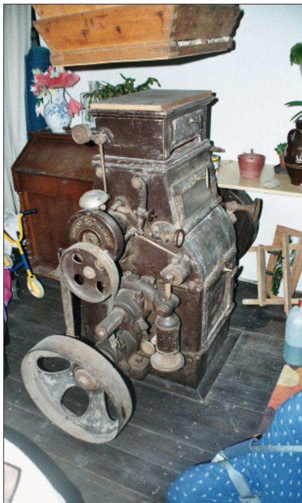
Obr. 16. Mlýn v Hroubovicích (CR). Mlecí stolice s rýhovanými válci pro mletí. Fa. J. Prokop Pardubice, r. 1910. Foto D. Veverka, 2011.
