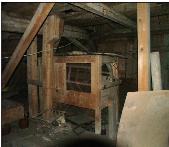
Obr. 4. Hamry čp. 45 (CR). Hranolový předvysěvač v podstřeší. Foto T. Ledvinka, 2007.
