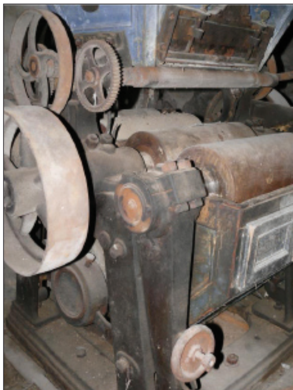
Obr. 8. Pustověty čp. 7 (RA). Válcová stolice Ganz – detail. Foto I. Minář, 2011.
