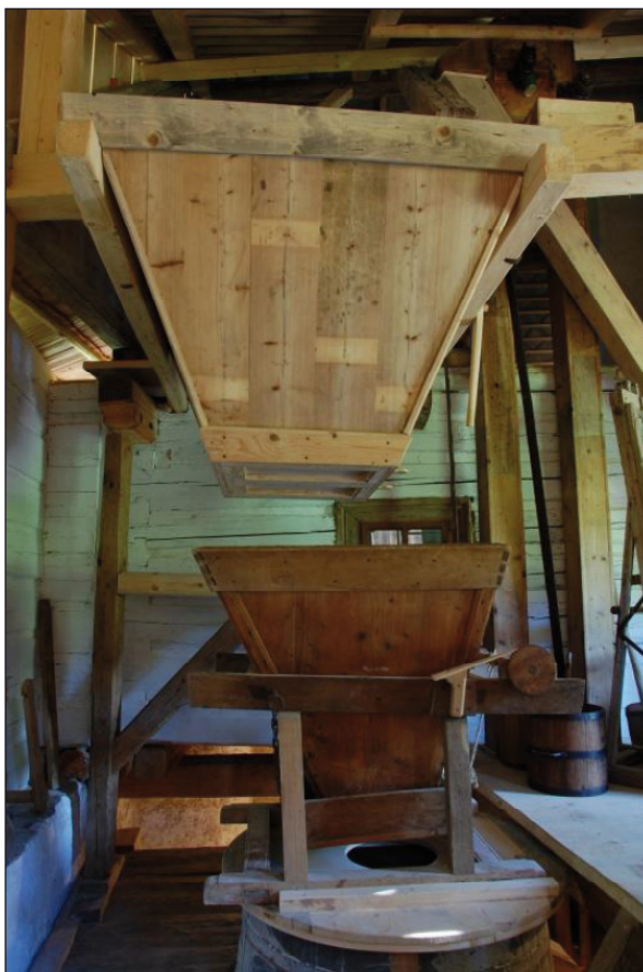
Obr. 53. MVS Vysoký Chlumec, transferovaný mlýn. Mlecí složení, násypka v přízemí. Foto 2011.
