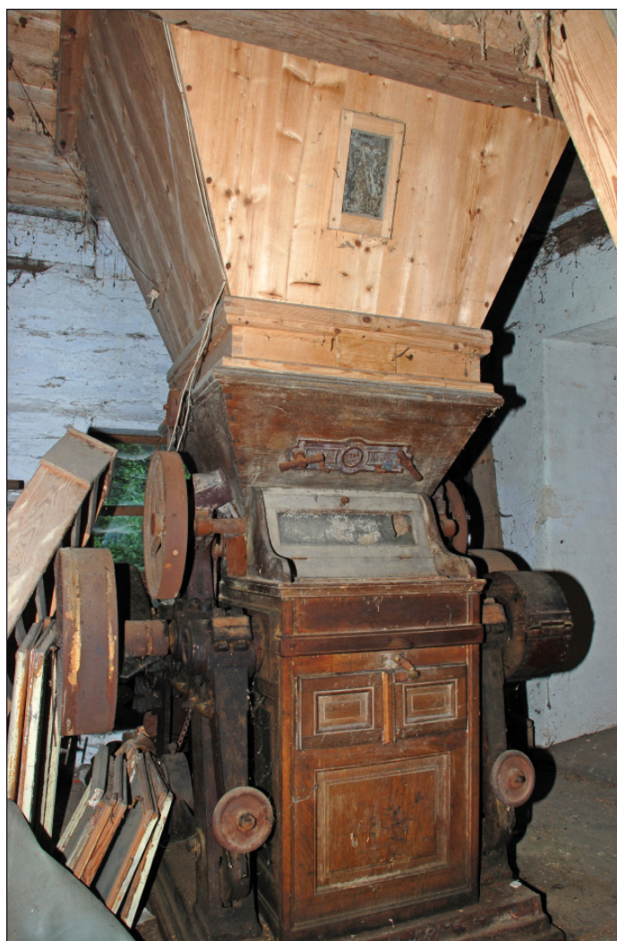
Obr. 20. Kunžak (JH) mlýn čp. 113. Válcová stolice Ganz & comp. Budapest v dřevěné skříni se dvěma páry válců. Přítlak zajišťuje archaickým a již jen výjimečně dochovaným způsobem závaží na pákách. Foto J. Pešta, 2010.
