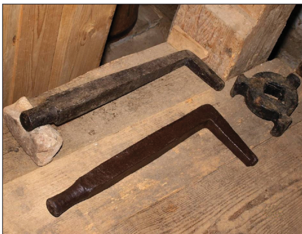
Obr. 11. Hoslovice (ST). Kované čepy hřídele vodního kola. Foto Muzeum středního Pootaví Strakonice, 2010.
