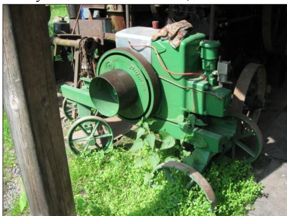
Obr. 49. Benzínový čtyřtakt, 5-6 HP, rok 1930-35, zapalování rotační magnetkou. Foto V. Medek, 2013.
