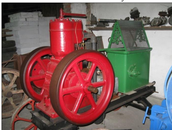
Obr. 19. Benzinový čtyřtakt, 8-10 HP, rok 1930. Foto V. Medek, 2013.
