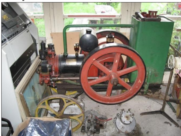
Obr. 47. Benzínový čtyřtakt, rok 1925-27, zapalování odtrhové, vysokonapěťové se zapalovací svíčkou. Foto V. Medek, 2013.
