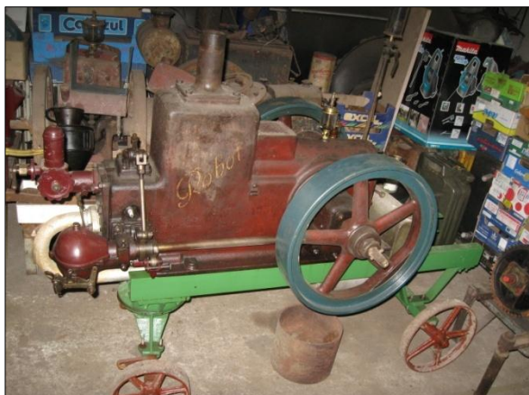
Obr. 22 a 23. Benzinový čtyřtakt, 4 HP, rok 1925, zapalování rotační magnetkou. Foto V. Medek, 2013.
