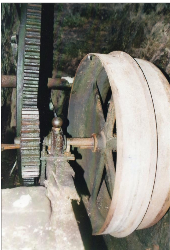
Obr. 20. Mariánská hora. Weberloch (okres Jablonec nad Nisou), brusírna čp. 567, pravoúhlý paleční převod od Girardovy turbíny. Foto D. Veverka, 2008.
