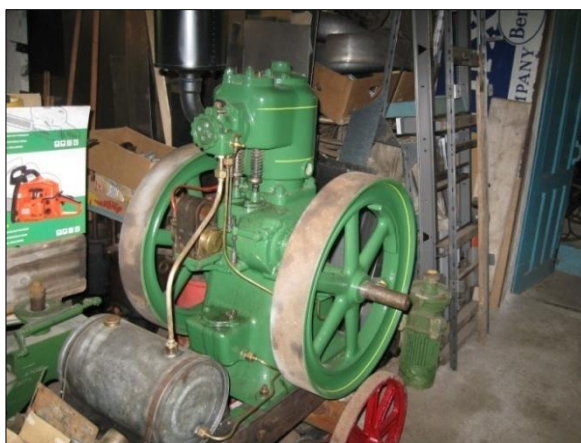
Obr. 17. Benzinový čtyřtakt, 4 HP, rok 1920-25. Foto V. Medek, 2013.
