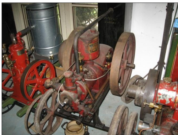
Obr. 43. Benzínový čtyřtakt, 4 HP, rok 1920, zapalování odtrhové vysokonapěťové se svíčkou. Foto V. Medek, 2013.
