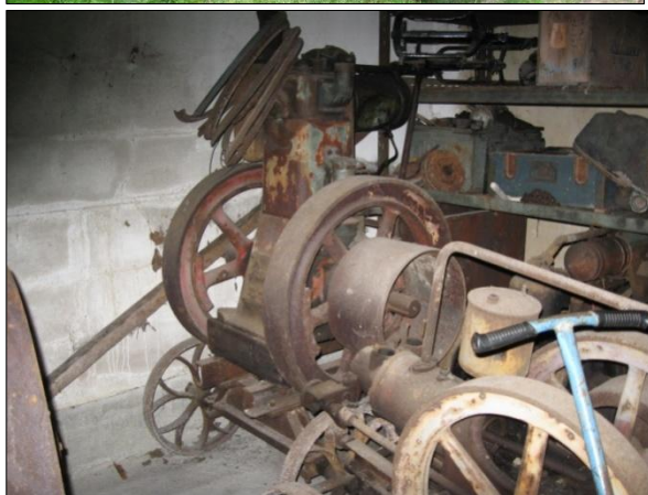
↑↑Obr. 12 a 13. Diesel čtyřtákní, 4 HP s přímým vstřikem. Foto V. Medek, 2013.
