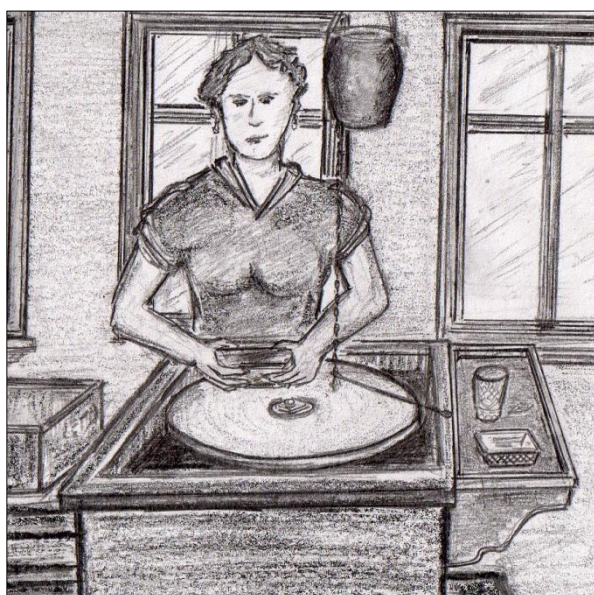
←Obr. 26. Práce na vertikální sklářské brusné stolici, zvané též hladinář. Kresba D. Veverka, 2012.
