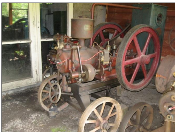
Obr. 7. Odtrhové zapalování vysokonapěťové - motor LORENZ, čtyřtákní, benzínový, 5-7 HP, rok 1925. Foto V. Medek, 2013.
