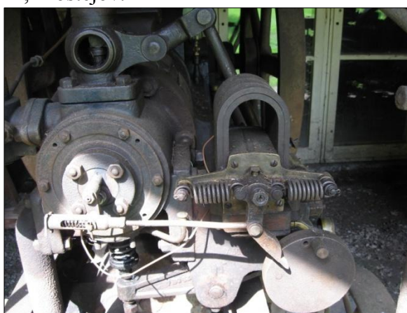
Obr. 20 a 21. Benzinový čtyřtakt, 8 HP, obsah 8 l, model 1910, zapalování nízkonapěťové, odtrhové. Foto V. Medek, 2013.
