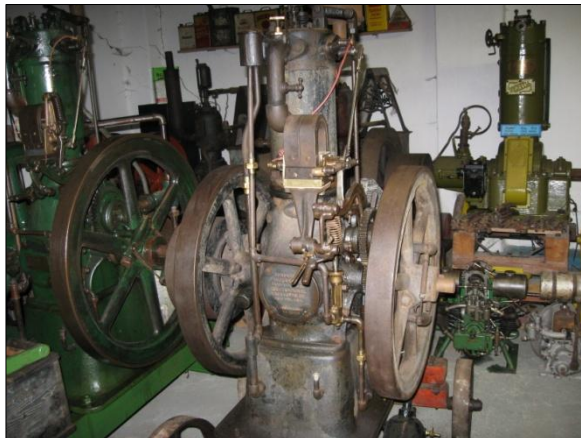
Obr. 31 a 32. Benzinový čtyřtakt, 3 HP, rok 1905-1910, zapalování odtrhové, nízkonapěťové. Motor má automatický sací ventil - mechanicky je pomocí vahadla ovládán pouze výfukový ventil. Sací ventil má slabou pružinu a je ovládán podtlakem při sání. Foto V. Medek, 2013. Jedinečný, výborný motor.
