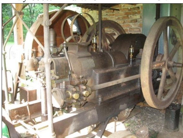
Obr. 20 a 21. Benzinový čtyřtakt, 8 HP, obsah 8 l, model 1910, zapalování nízkonapěťové, odtrhové. Foto V. Medek, 2013.
