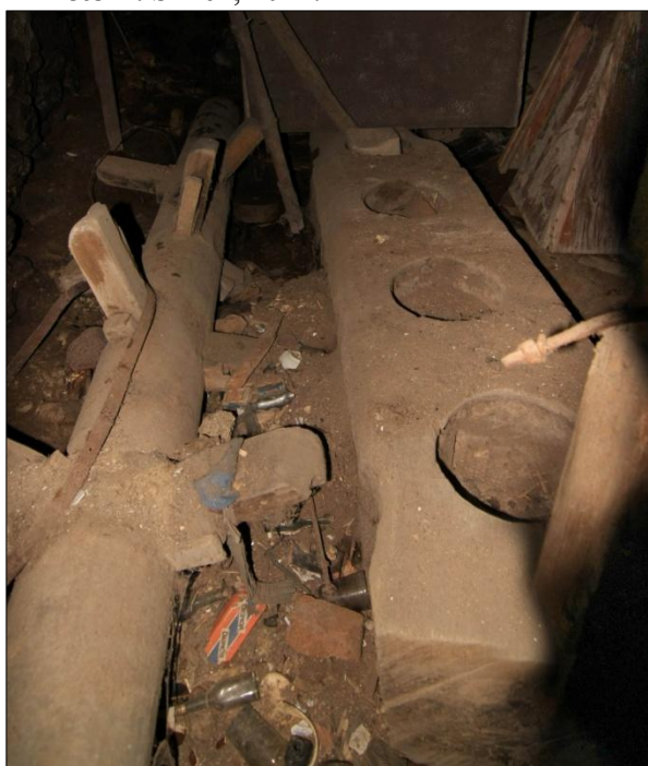
Obr. 15. Hřidel s hejblaty a mohutný dřevěný štok se čtyřmi otvory v Párisově mlýně čp. 6 (BN). Foto R. Šimek, 2012.
