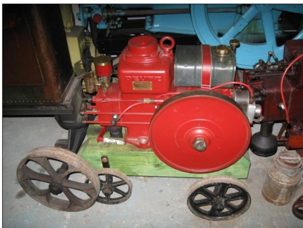
Obr. 45. Benzínový čtyřtakt, 3-4 HP, rok 1930, zapalování rotační magnetkou. Foto V. Medek, 2013.
