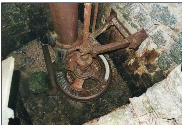
Obr. 14. Karlov (okres Jablonec nad Nisou), brusírna čp. 345, vzácná Girardova turbína. Foto D. Veverka, 2008.
