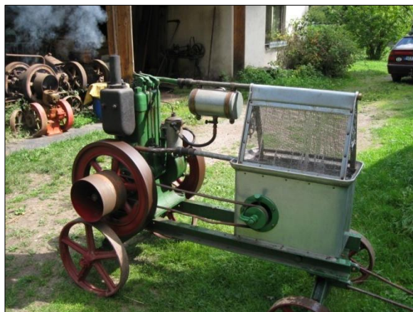
↑↑Obr. 12 a 13. Diesel čtyřtákní, 4 HP s přímým vstřikem. Foto V. Medek, 2013.
