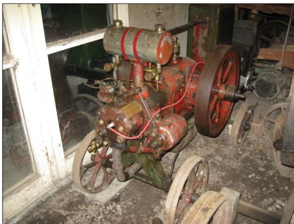
↑Obr. 24. Benzinový čtyřtakt, 4 HP, rok 1920, zapalování odtrhové, vysokonapěťové. Foto V. Medek, 2013.
