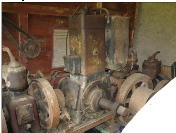
Obr. 50. Dvoutaktní diesel o výkonu 8-10 HP. Foto V. Medek, 2013.
