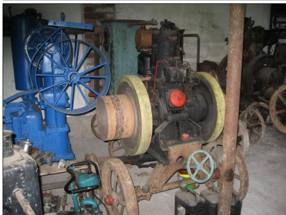
↑Obr. 24. Benzinový čtyřtakt, 4 HP, rok 1920, zapalování odtrhové, vysokonapěťové. Foto V. Medek, 2013.
