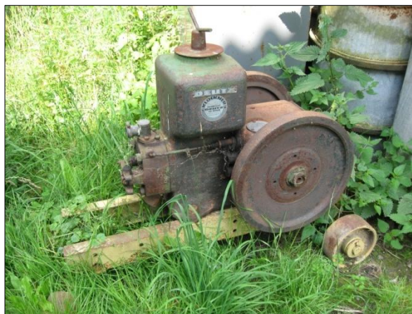
Obr. 45. Benzínový čtyřtakt, 3-4 HP, rok 1930, zapalování rotační magnetkou. Foto V. Medek, 2013.
