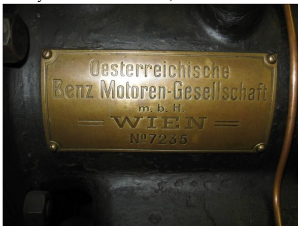
Obr. 35 a 36. Jedná se o unikát - motor na benzín a plyn, 4-5 HP, vyroben do roku 1910, zapalování nízkonapěťové, odtrhové. Foto V. Medek, 2013.↑↑
