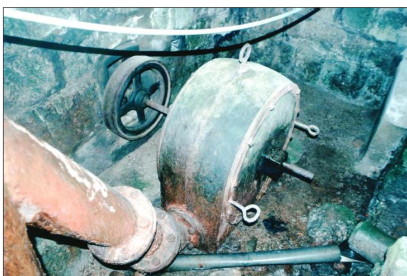
Obr. 16. Malý Semerink (okres Jablonec nad Nisou), brusírna čp. 1081, vzácná Peltonova turbína z konce 19. století. Foto D. Veverka, 2009.
