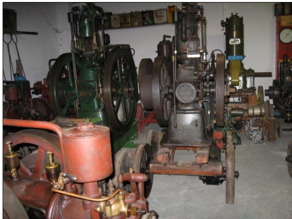
Obr. 31 a 32. Benzinový čtyřtakt, 3 HP, rok 1905-1910, zapalování odtrhové, nízkonapěťové. Motor má automatický sací ventil - mechanicky je pomocí vahadla ovládán pouze výfukový ventil. Sací ventil má slabou pružinu a je ovládán podtlakem při sání. Foto V. Medek, 2013. Jedinečný, výborný motor.
