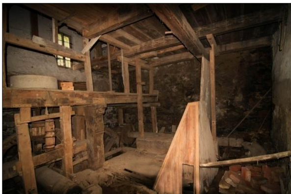
Obr. 13. Pohled do mlýnice Párisova mlýna čp. 6 u obce Nedvězí (BN). Za násypkou téměř dochovaná tyčová stoupa s hnacím ústrojím. Foto R. Šimek, 2012.
