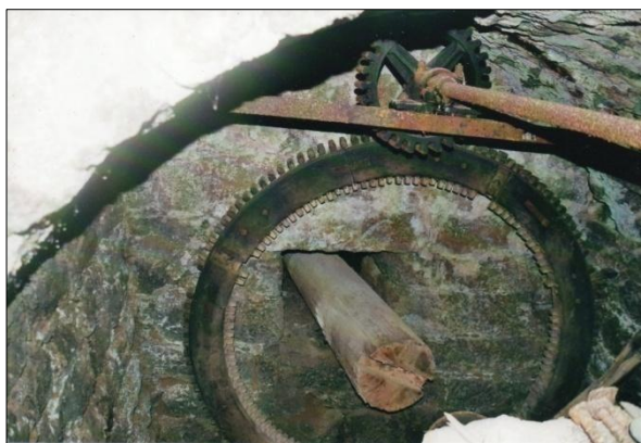
Obr. 21. Smržovka (okres Jablonec nad Nisou), brusírna čp. 85, litinový ozubený převod čelní od vodního kola na transmisi. Foto D. Veverka, 2009.
