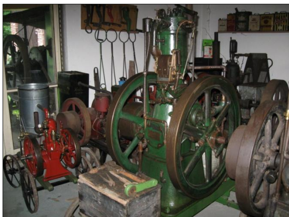
Obr. 33. Benzinový čtyřtakt, 3 HP, rok 1910. Má zapalování nízkonapěťové, odtrhové a automatický sací ventil. Je to kopie motoru I. H. C. zobrazeného na obr. 31 a 32. Foto V. Medek, 2013.
