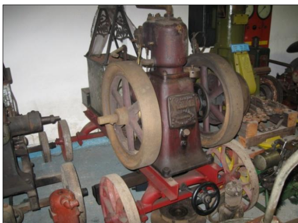
Obr. 17. Benzinový čtyřtakt, 4 HP, rok 1920-25. Foto V. Medek, 2013.
