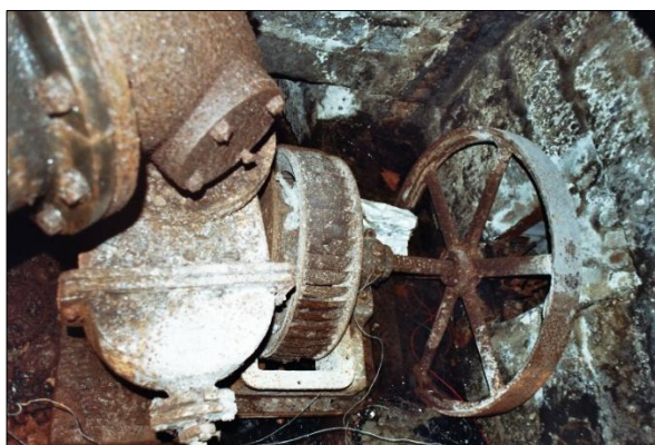
Obr. 13. Karlov (okres Jablonec nad Nisou), brusírna čp. 65, Schwamkrugova turbina s odejmutým vrchním krytem, vidět je zde oběžné kolo. Foto D. Veverka, 2008.
