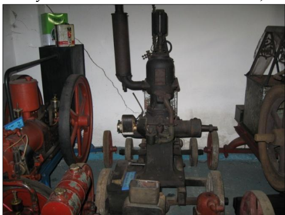
Obr. 42. Benzínový dvoutakt s deflektorem, rok přibližně 1920, zapalování rotační magnetkou. Foto V. Medek, 2013.
