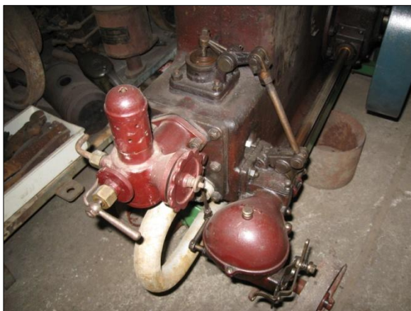
Obr. 22 a 23. Benzinový čtyřtakt, 4 HP, rok 1925, zapalování rotační magnetkou. Foto V. Medek, 2013.
