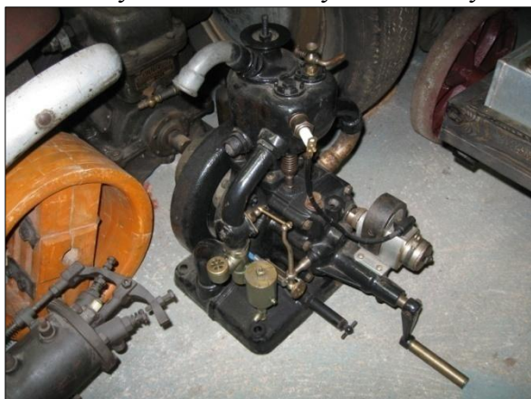
Obr. 8. Zapalování rotační magnetkou - motor FAFNIER, Cáchy, čtyřtakt, rok 1910. Foto V. Medek, 2013.
