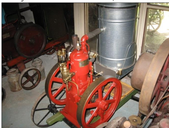
Obr. 38 a 39. Benzinový motor s nízkotlakým vstřikováním benzínu, rok 1910, zapalování bateriové. Motor lze reverzovat za chodu. Jedná se opět o unikát - na světě existují údajně pouze tři exempláře a z toho jsou dva kusy v USA. Foto V. Medek, 2013.
