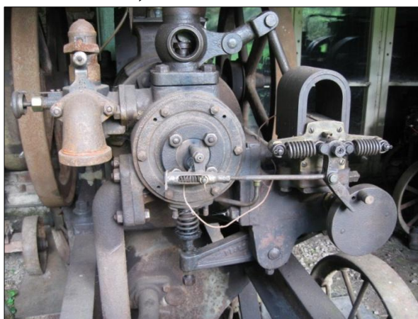
Obr. 6. Detail odtrhového zapalování nízkonapětového. Motor WICHTERLE A KOVAŘÍK, 8 HP, benzínový čtyřtakt, rok 1910. Foto V. Medek, 2013.
