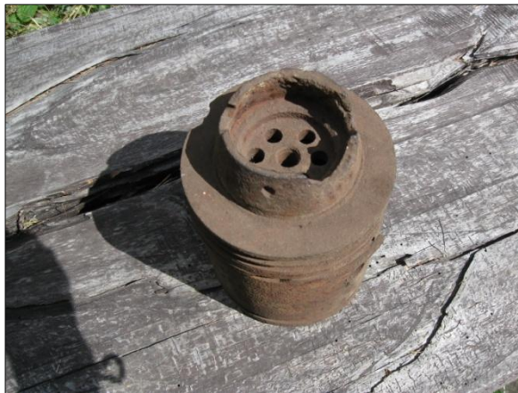
Obr. 29. Benzinový dvoutakt s ventilem v pístu, 4 HP, rok 1910, zapalování rotační magnetkou. Foto V. Medek, 2013.
