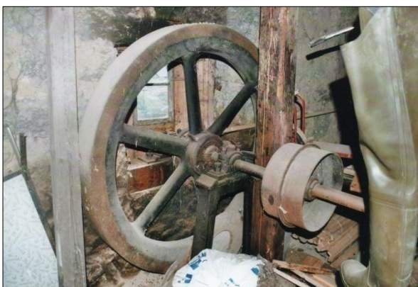
Obr. 19. Josefův Důl (okres Jablonec nad Nisou), brusírna čp. 887, setrvačník na transmisi. Foto D. Veverka, 2008.
