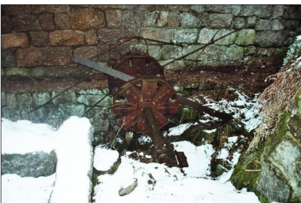
Obr. 11. Josefův Důl (okres Jablonec nad Nisou), brusírna čp. 701, kovová hřídel s disky (rozeta) vodního kola. Foto D. Veverka, 2009.
