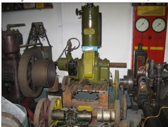
Obr. 41. Diesel, dvoutakt, 12 HP rok 1932, sání membránou. Foto V. Medek, 2013.
