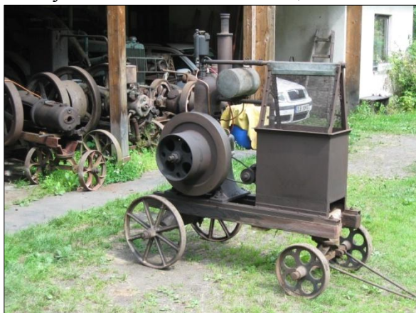
Obr. 27 a 28. Benzinový dvoutakt s ventilem v pístu, 4 HP, rok 1910, zapalování rotační magnetkou. Foto V. Medek, 2013.
