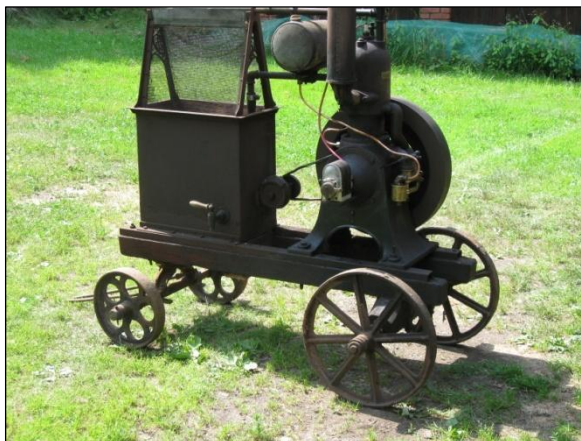
Obr. 27 a 28. Benzinový dvoutakt s ventilem v pístu, 4 HP, rok 1910, zapalování rotační magnetkou. Foto V. Medek, 2013.
