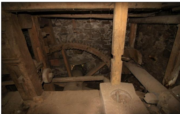
Obr. 14. Paleční kolo s převodem na stoupu a část štoku v Párisově mlýně čp. 6 (BN). Foto R. Šimek, 2012.
