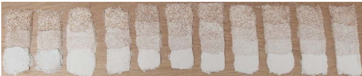
Mlynářská zkouška – 11 průchodů meliva přes mlecí kameny a moučnici
