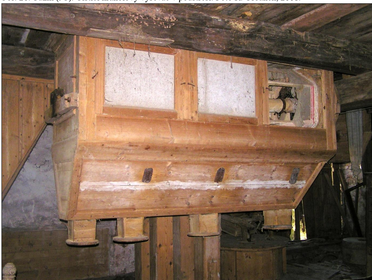
Obr. 22. Tužín (JC). Moučný hranolový vysévač na mlecí podlaze. Foto R. Urbánek, 2008.
