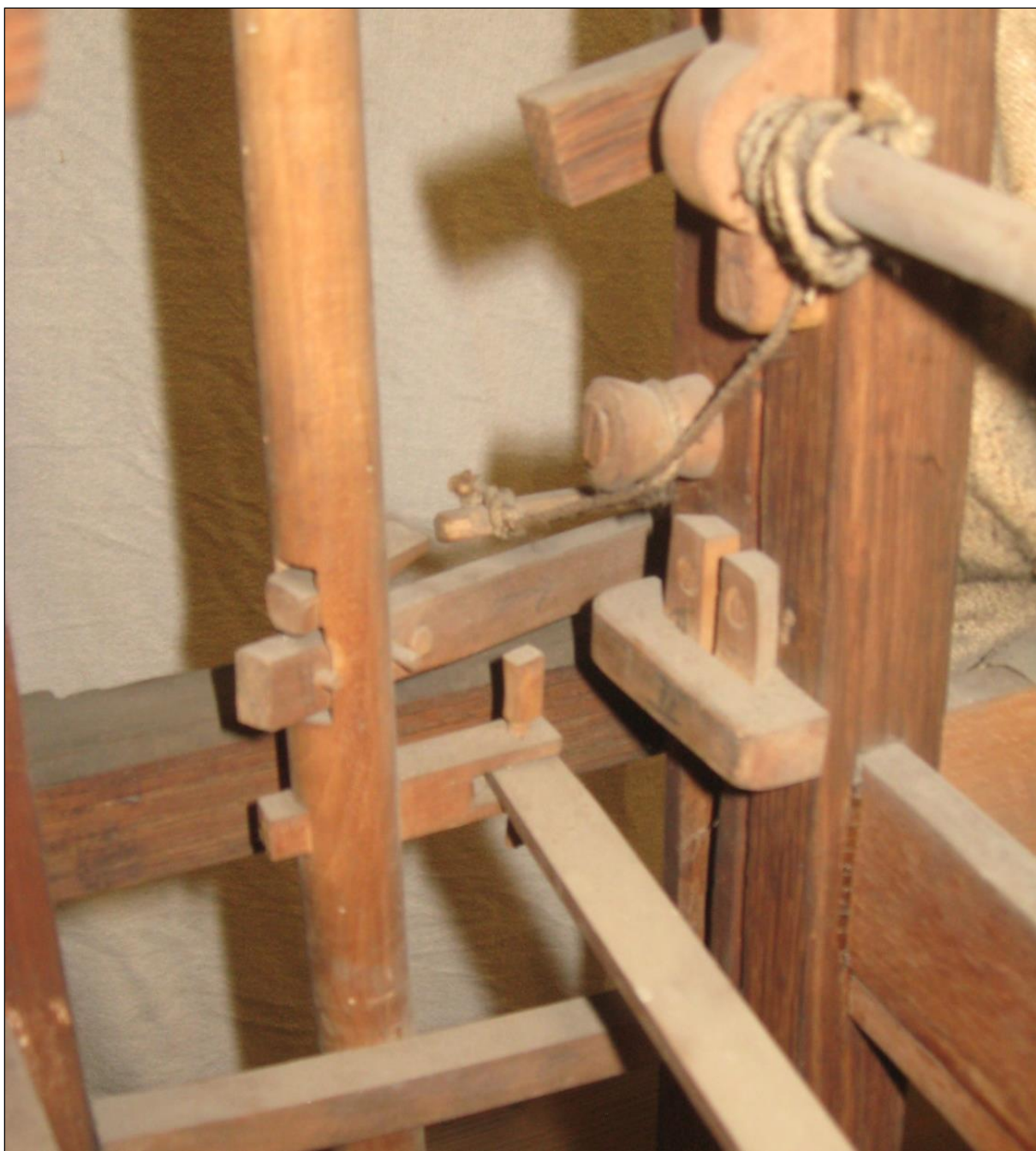
Obr. 5. Detail napínacího mechanizmu hasačertu.
