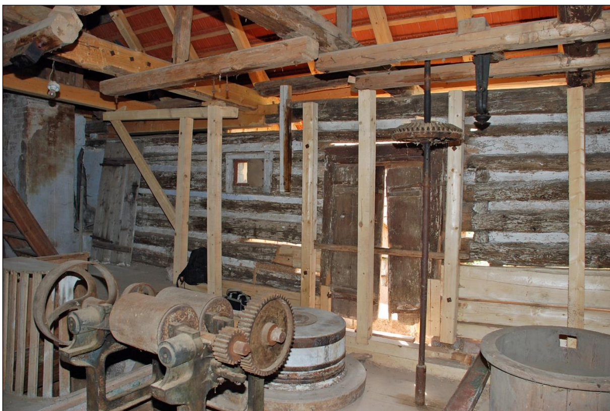
Obr. 4. Bradlecká Lhota (SE). Pohled na mlecí podlahu, pozici mlecí stolice a mlecích kamenů. Foto J. Pešta, 2013.
