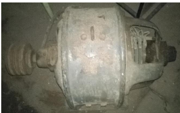
Obr. 15. Dynamo přestavěné na alternátor. Foto J. Svatoš, 2016.
