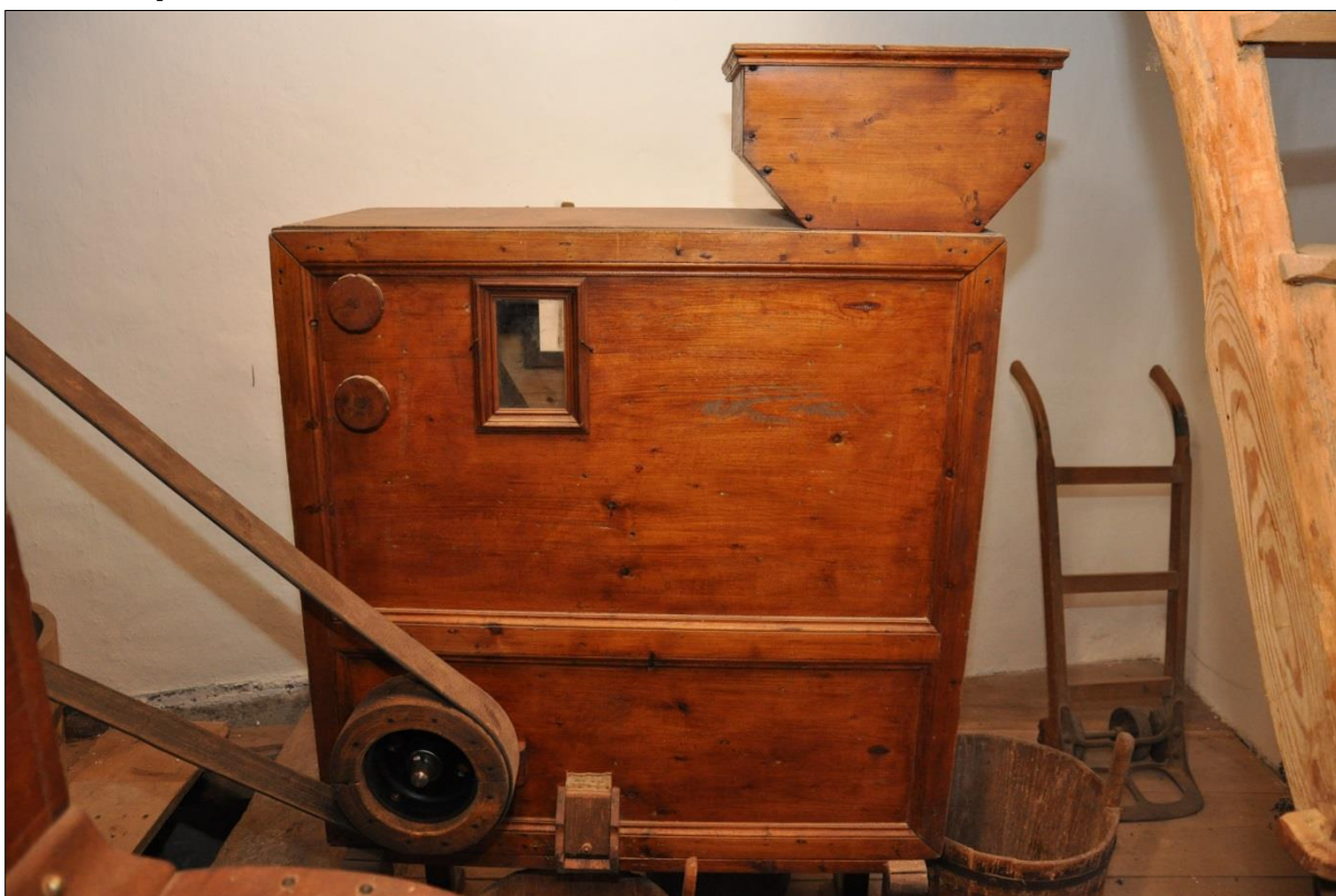
Obr. 9. Zdechův mlýn, Světce čp. 13 (JH), ssavka na čištění krupic řemeslné výroby z poč. 20. stol., restauroval David veverka. Foto D. Veverka, 2013.
