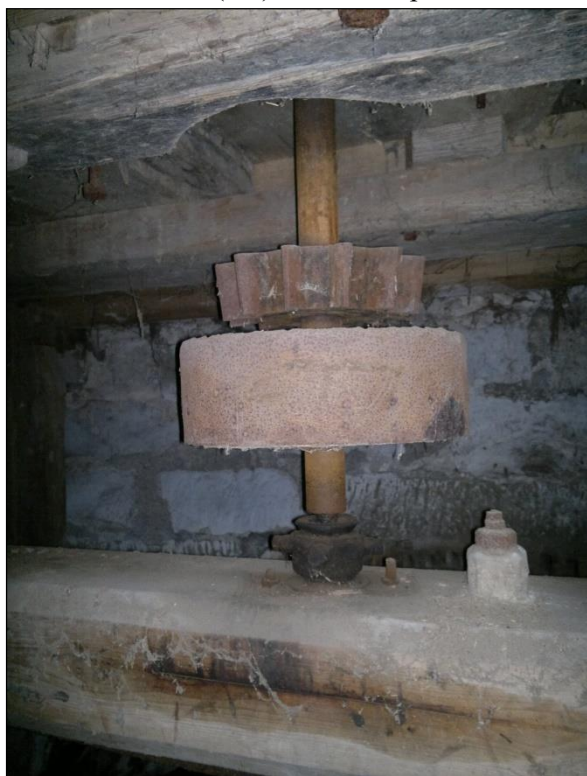
Obr. 26. Němčice (SY). Železí kamenného složení s francouzskými kameny a řemenice, která poháněla složení špicovací. Foto D. Veverka, 2013.
