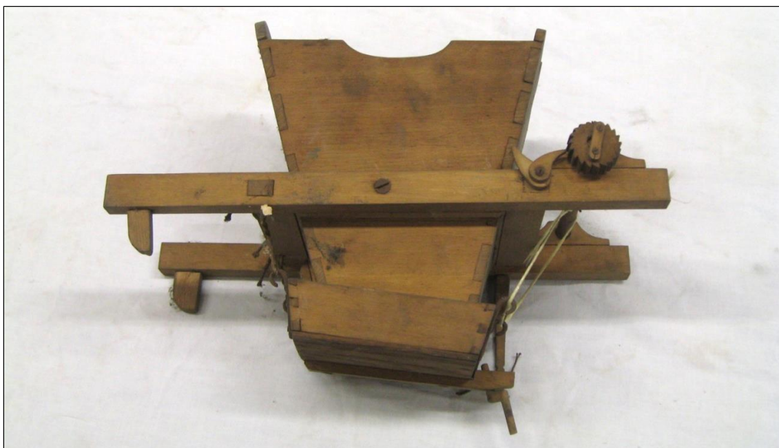
Obr. 14. Násypný koš se štálci a a korčákem a rejholcem.
