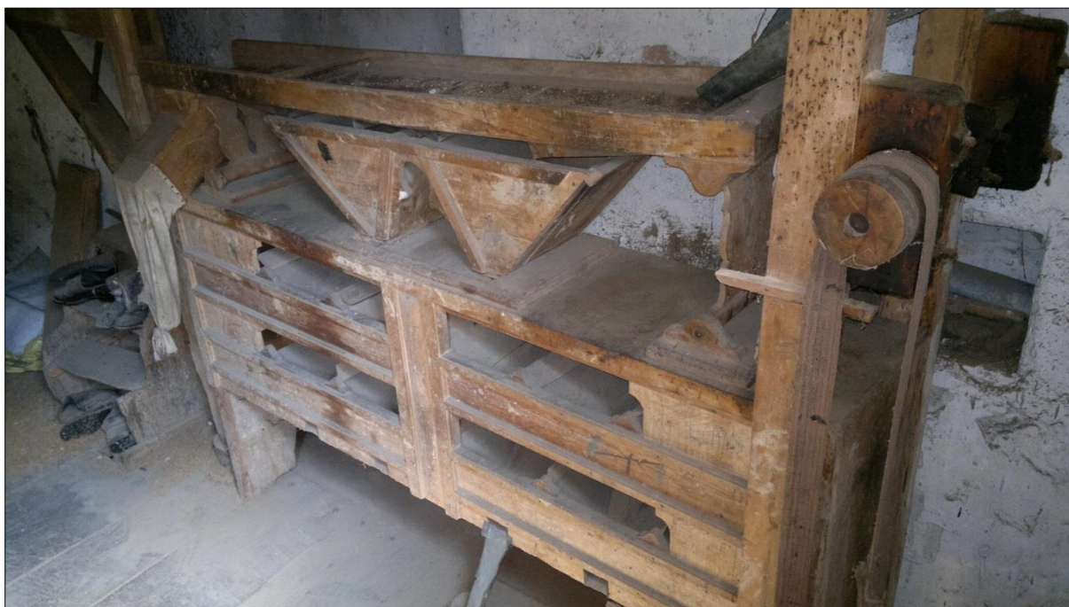
Obr. 7. Mlýn Choryně čp. 32 (VS), štoska s žejbrem na čištění a třídění krupic i krupiček, řemeslná výroba z roku 1885. Foto D. Veverka, 2012.
