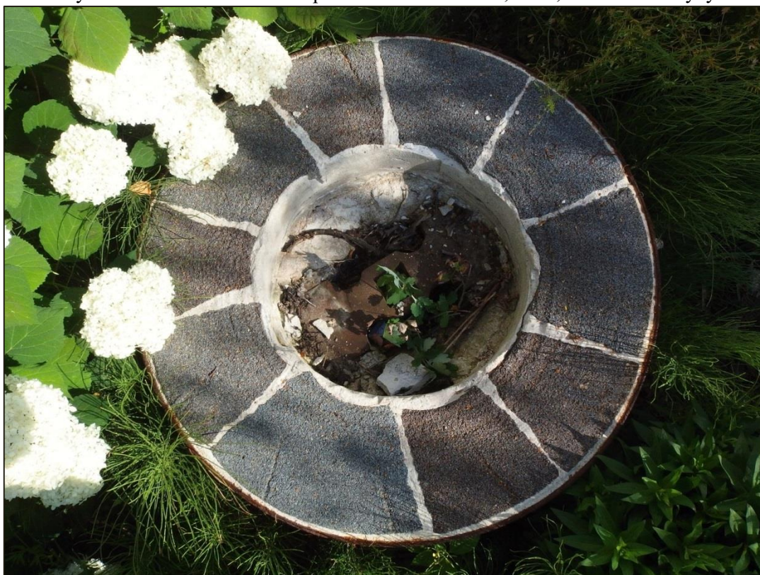
Obr. 12. Atypický skládaný smirkový kámen se stopami mletí tvrdých materiálů. Býkovice č. p. 25. Foto L. Kovář, 2015.
