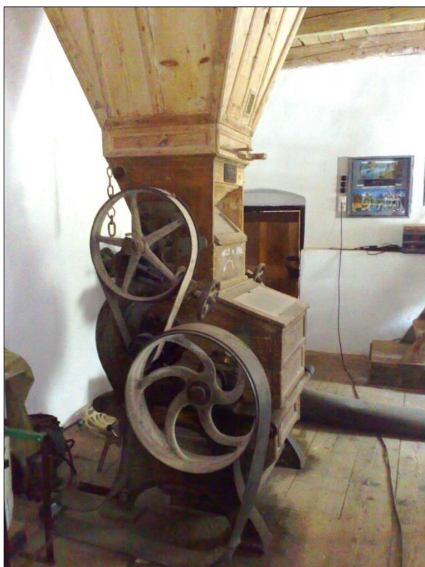
Obr. 4. Mlýn Kladná – Žilín čp. 84 (ZL), válcová mlecí stolice z konce 19. stol. od výrobce strojírna knížete Salma – Blansko. Foto D. Veverka, 2007 - 2014.
