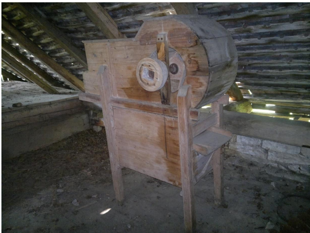
Obr. 15. Mlýn Bělá čp. 1 (CR), tarár se žejbrem na čištění zrna, řemeslně zhotovil František Macák v Luži v roce 1898. Foto D. Veverka, 2011.
