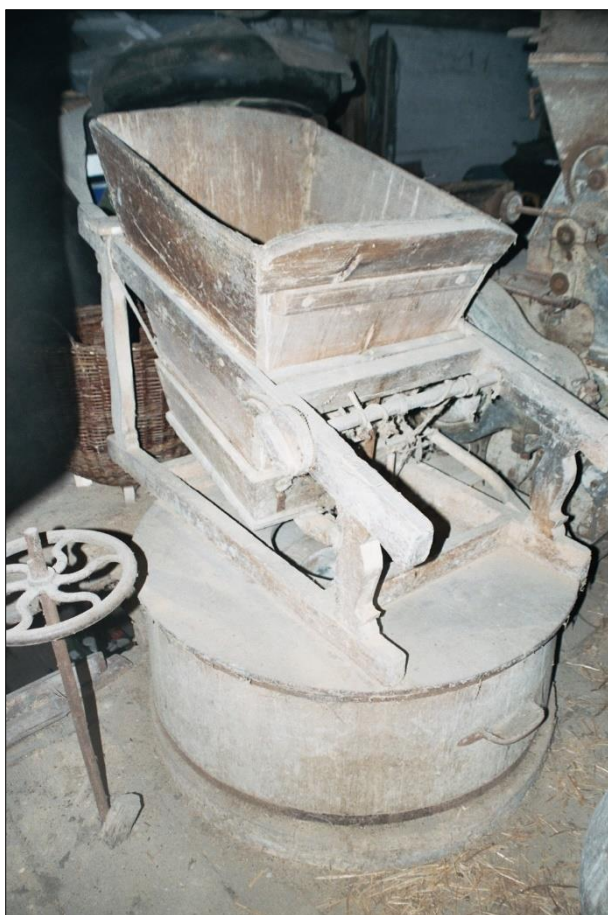
Obr. 24. Mlýn Popovec – Bětník čp. 34 (CR), kamenné mlecí složení s regulací lehčení z 2. pol. 19. stol. Foto D. Veverka 2008.
