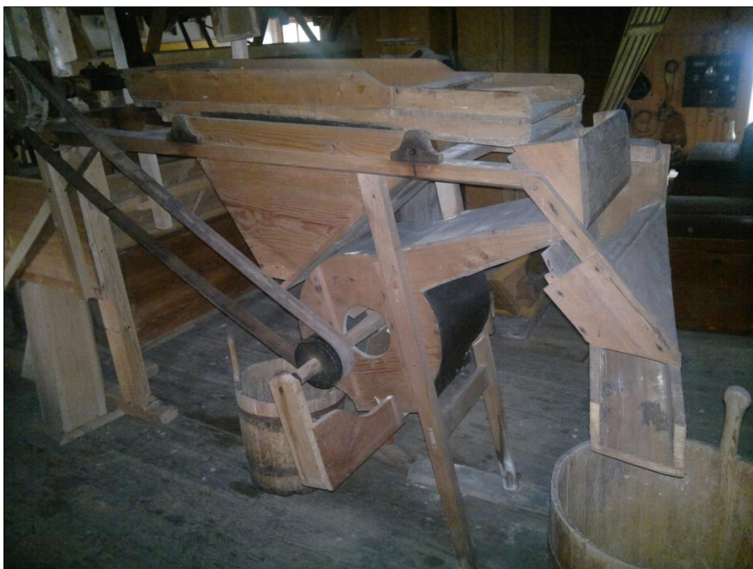
Obr. 16. Karlíkův mlýn, Kozodry čp. 11 (RK), tarár se žejbrem na čištění zrna, výroba řemeslná z počátku 20. stol. Foto D. Veverka, 2013.
