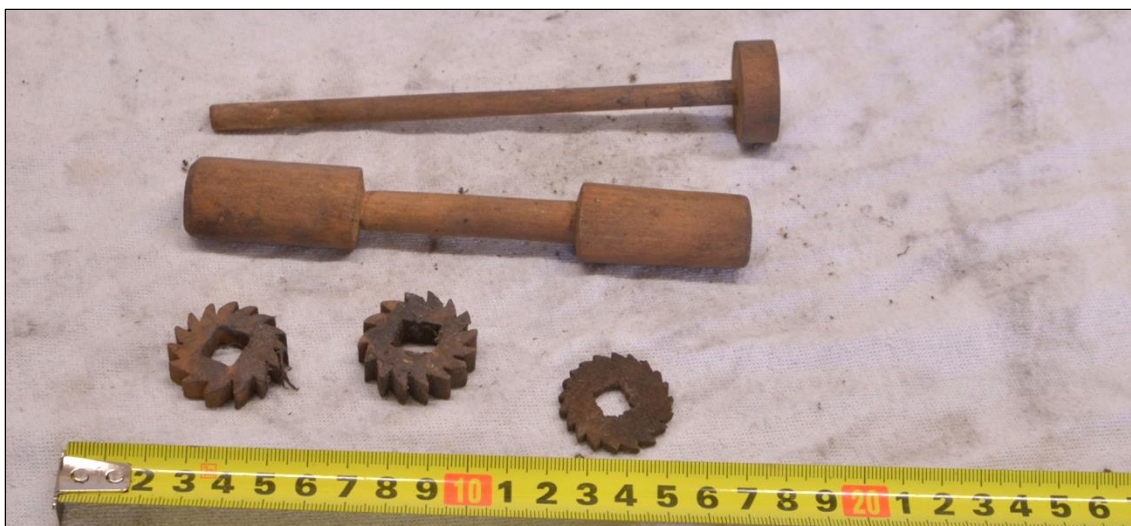
Obr. 16. Rohatka a vyjmuté části mechanismu z horního násypného koše.
