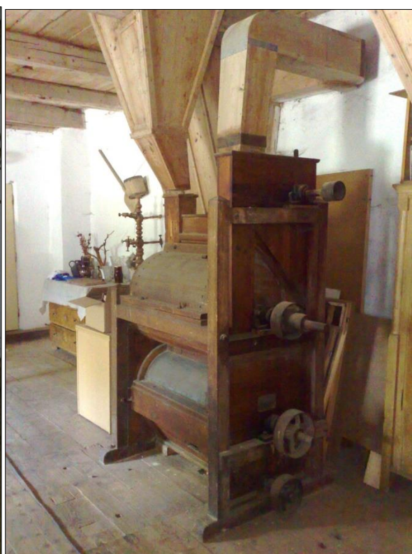
Obr. 5. Kopejtkův horní mlýn, Počátky čp. 339 (PE), válcová mlecí stolice od firmy J. Hübner a K. Opitz – Pardubice, kolem roku 1892. Foto D. Veverka, 2014.
