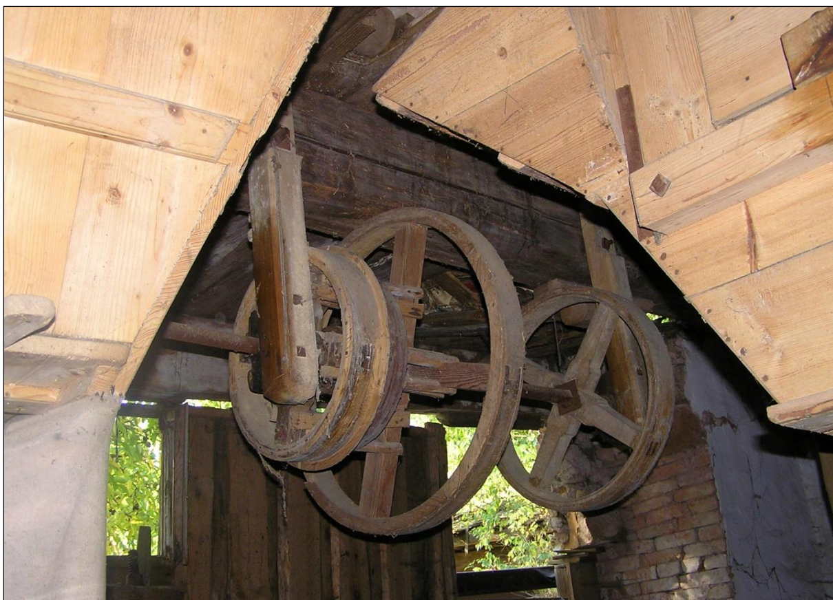
Obr. 23. Tužín (JC). Dřevěné řemenice transmise, zavěšené na dř. věšadlech. Foto R. Urbánek, 2008.
