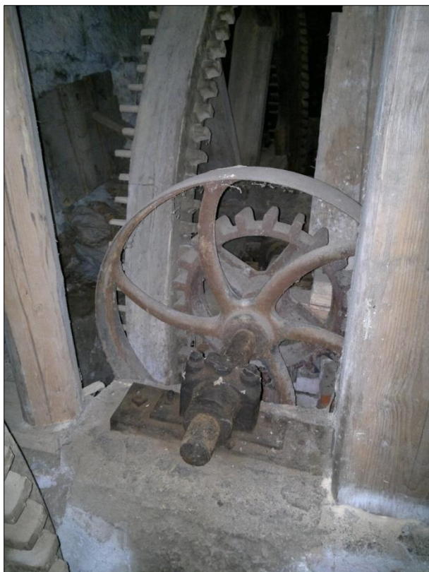
Obr. 20. Kopejtkův horní mlýn, Počátky čp. 339 (PE), paleční převod pravoúhlý na předlohouovou transmisi. Foto David Veverka, 2014.
