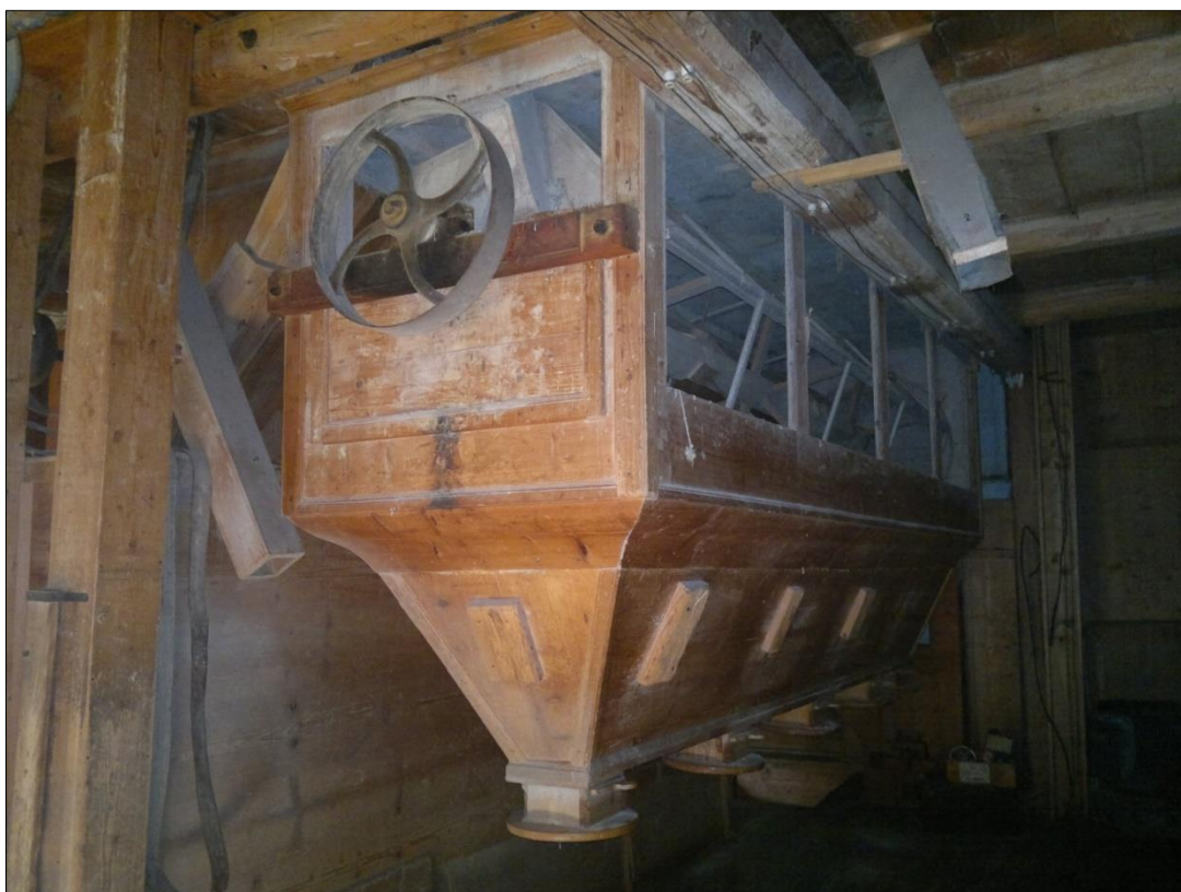
Obr. 12. Janatův mlýn, Buřany čp. 37 (SM), hranolový vysévač moučný na třídění mlýnských produktů, výroba řemeslná z poslední čtvrtiny 19. stol. Foto D. Veverka, 2012.
