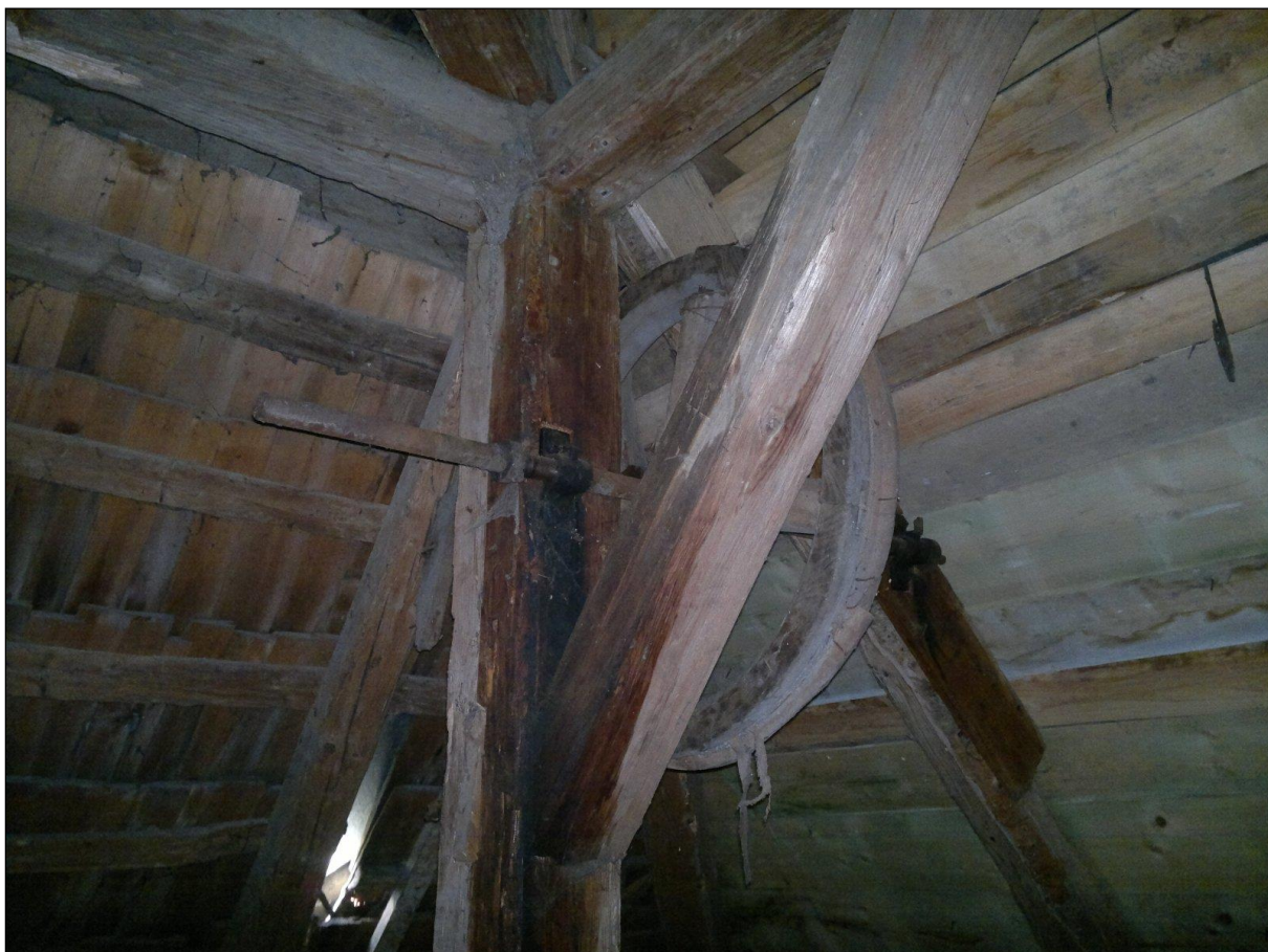
Obr. 29. Němčice (SY). Dřevěná řemenice v podstřeší. Foto D. Veverka, 2013.
