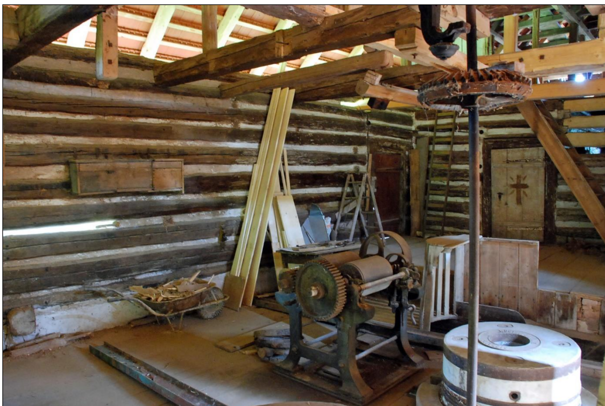
Obr. 3. Bradlecká Lhota (SE). Pohled na mlecí podlahu. V popředí královská hřídel a jedno věšadlo po transmisi, francouzský kámen bez lubu a torzo válcové stolice. Foto J. Pešta, 2013.
