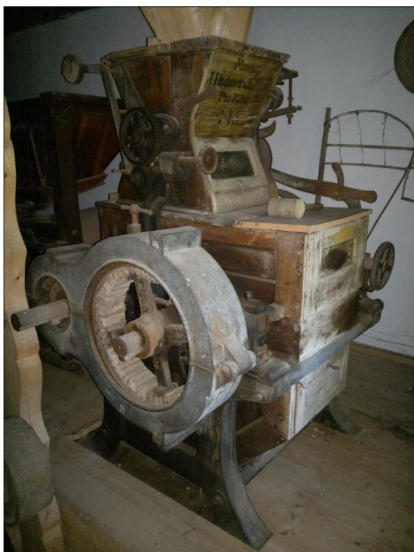
Obr. 5. Kopejtkův horní mlýn, Počátky čp. 339 (PE), válcová mlecí stolice od firmy J. Hübner a K. Opitz – Pardubice, kolem roku 1892. Foto D. Veverka, 2014.
