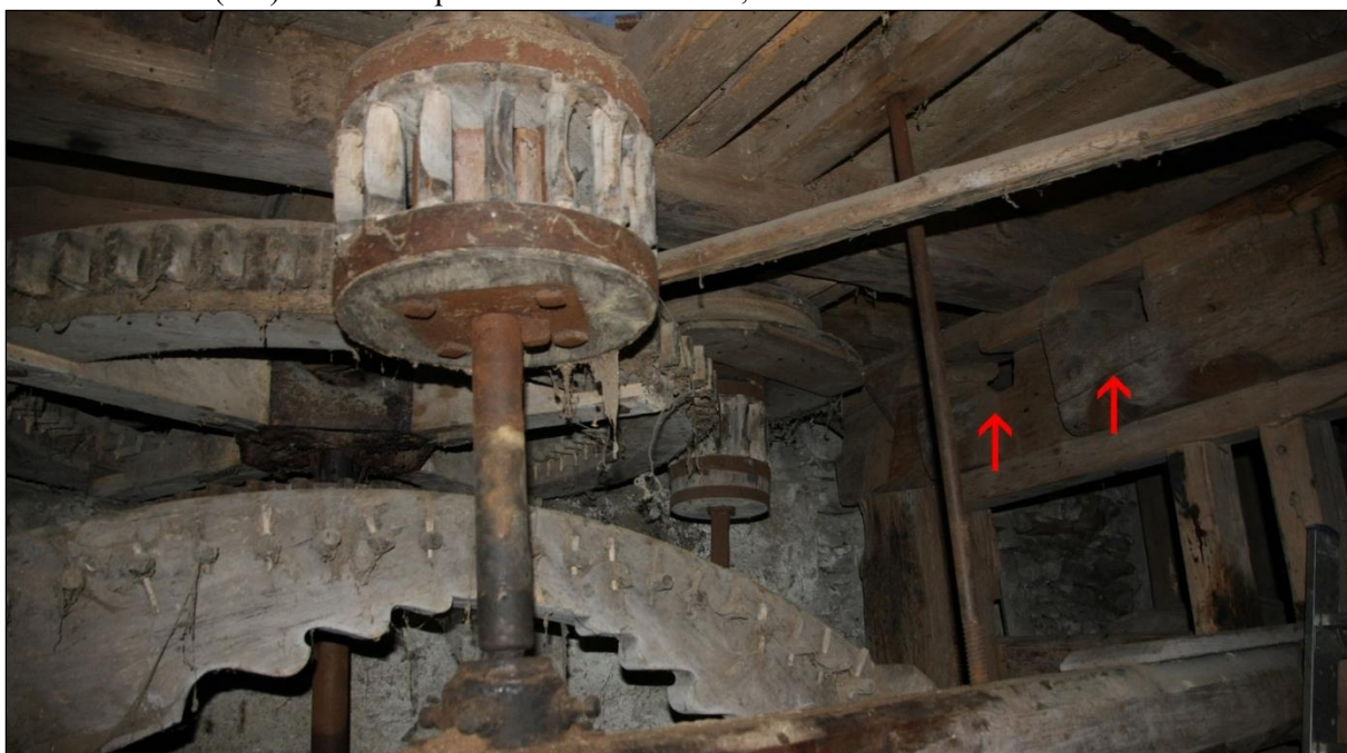
Obr. 33. Votice (BN). Převody v podkolí s vyznačenými prostupy pro plochý řemen, který poháněl kamenné složení (špicák?). Foto R. Šimek, 2014.
