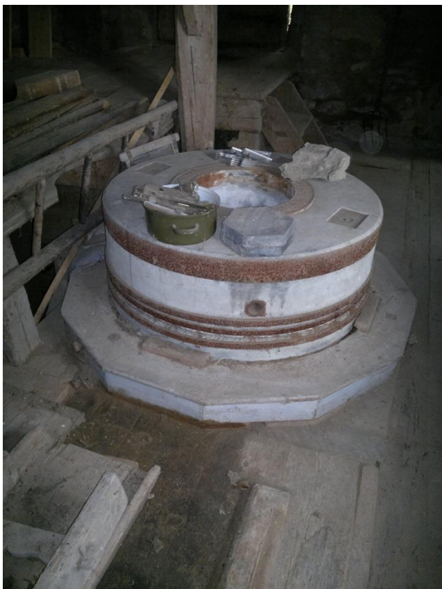
Obr. 28. Němčice (SY). Kamenné složení s francouzskými kameny bez lubu od firmy J. Hübner & K. Opitz. Foto D. Veverka, 2013.
