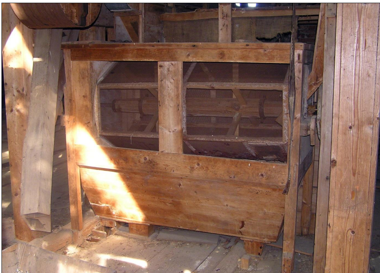
Obr. 21. Tužín (JC). Čistící hranolový vysévač v podstřeší. Foto R. Urbánek, 2008.
