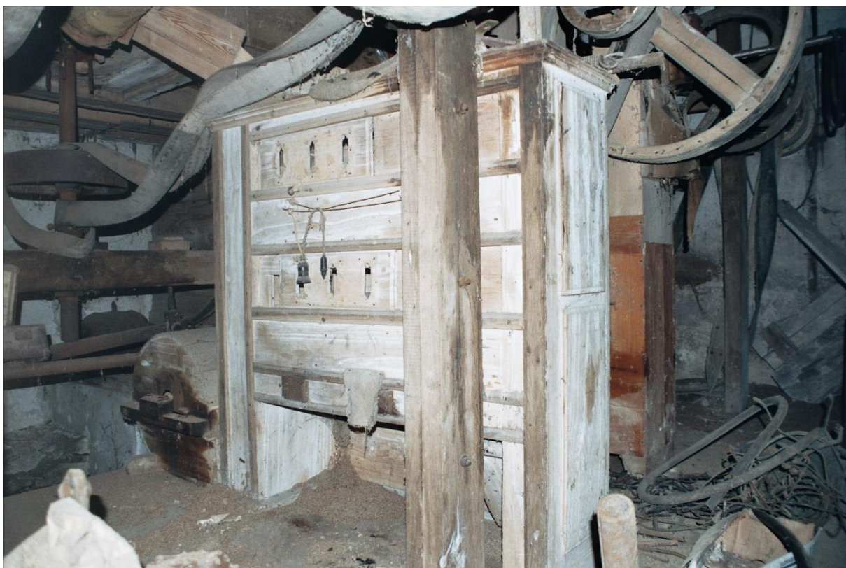
Obr. 8. Rozlivkův mlýn, Vraclav- Svatý Mikuláš čp. 12 (UO), štoska na čištění a třídění jáhel, řemeslná výroba z konce 19. stol. Foto D. Veverka, 2009.
