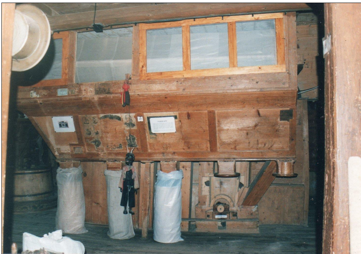
Obr. 13. Roztoky u Semil (SE). Mohutný moučný vysévač na mlecí podlaze. Foto D. Veverka, 2008.
