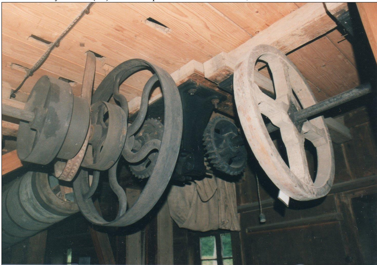
Obr. 10. Roztoky u Semil (SE). Pravoúhlý převod na transmisi (královská hřídel se nedochovala). Foto D. Veverka, 2008.
