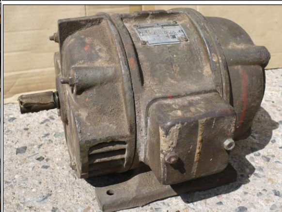
Obr. 13. Synchronní generátor ŠKODA s budičem. Foto J. Svatoš, 2016.
