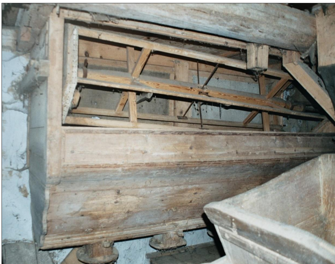
Obr. 13. Mlýn Popovec – Bětník čp. 34 (CR), hranolový vysévač moučný na třídění mlýnských produktů, výroba řemeslná z poslední čtvrtiny 19. stol. Foto D. Veverka 2008.
