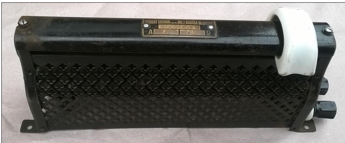
Obr. 8. Reostat k regulaci dynama. Foto J. Svatoš, 2016.
