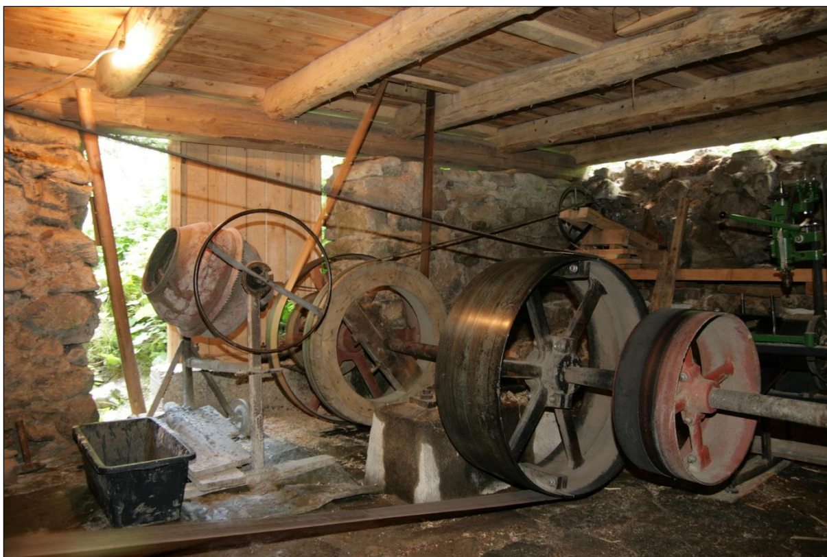
Obr. 4. Transmisia mlyna. Energia vodného kola každodenne slúži na pohon rozličných strojov. Okrem pôvodnej gátrovej píly a kamenného mlecieho zloženia remene poháňajú napríklad aj elektrický generátor, hobľovačku, vŕtačku, brúsku, cirkulár, či dokonca miešačku na betón. Foto M. Petráš, 2008.
