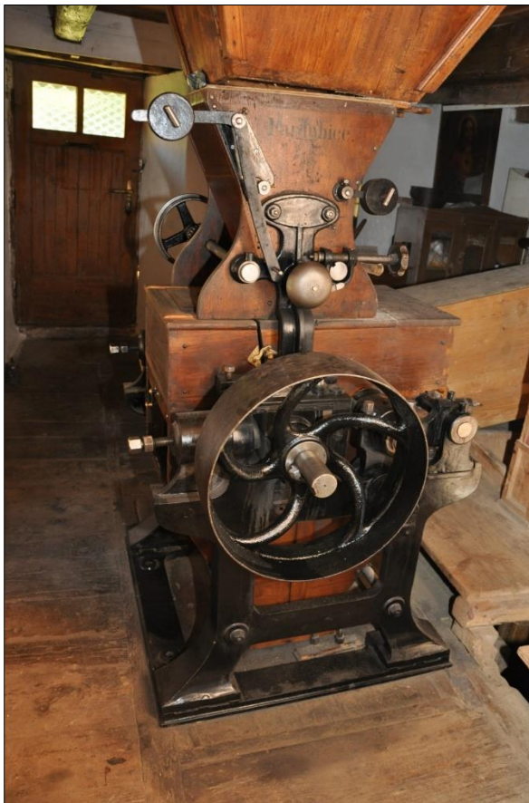
Obr. 1. Mlýn Javorníček čp. 8 (UO), válcová mlecí stolice s rýhovanými válci od výrobce Josef Prokop Vdova – Pardubice, kolem r. 1888. Foto D. Veverka, 2008.
