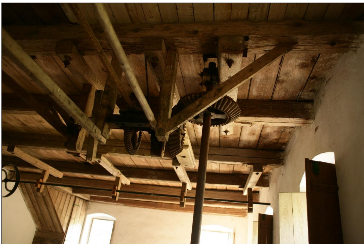
Obr. 42. Kouřim (KO). Detail převodu z královské hřídele na krátkou transmisi. Foto R. Haluska, 2012.
