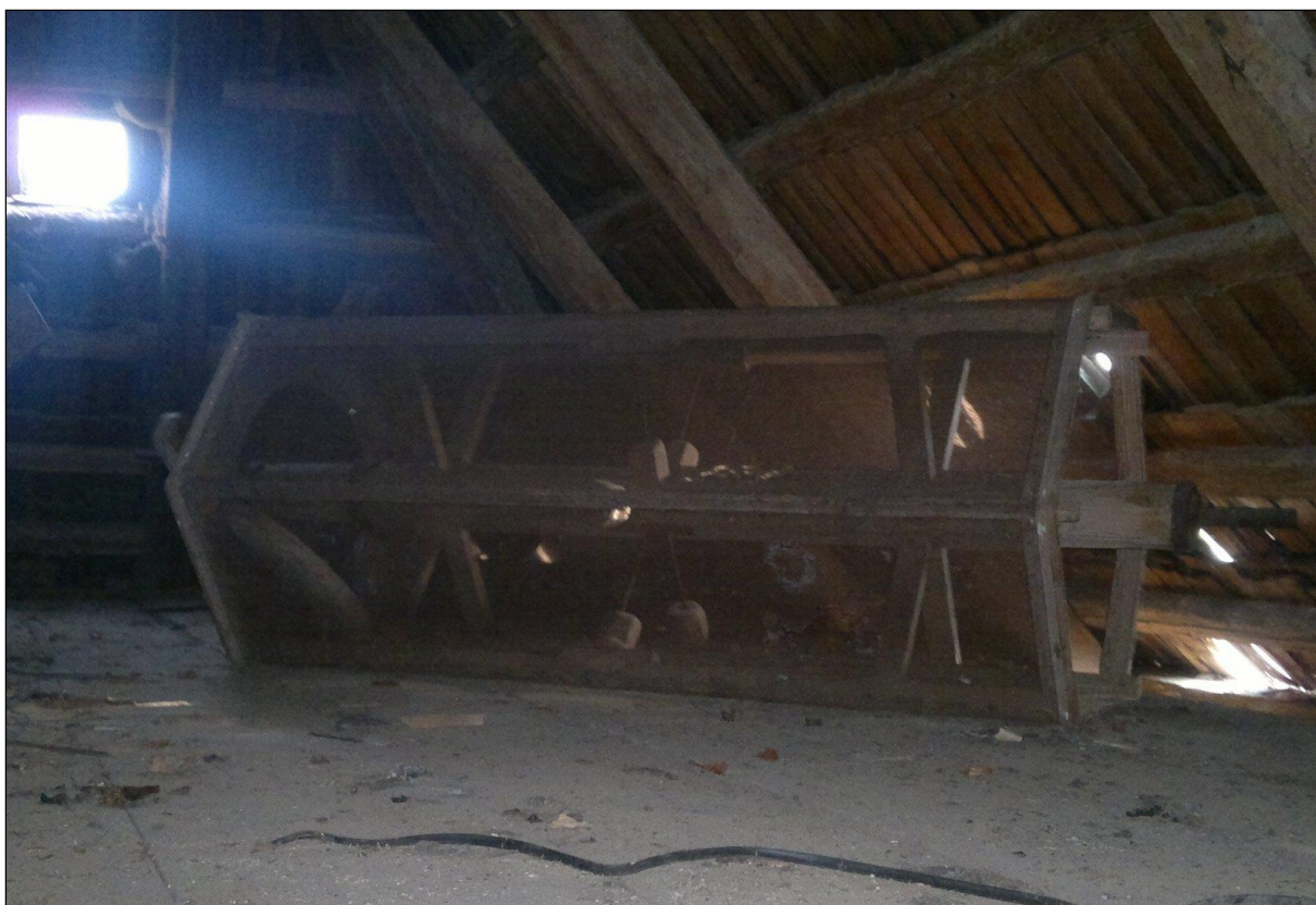
Obr. 30. Němčice (SY). Moták z hranolového vysévače (nejspíš předvysévač s drátěnými síty). Foto D. Veverka, 2013.
