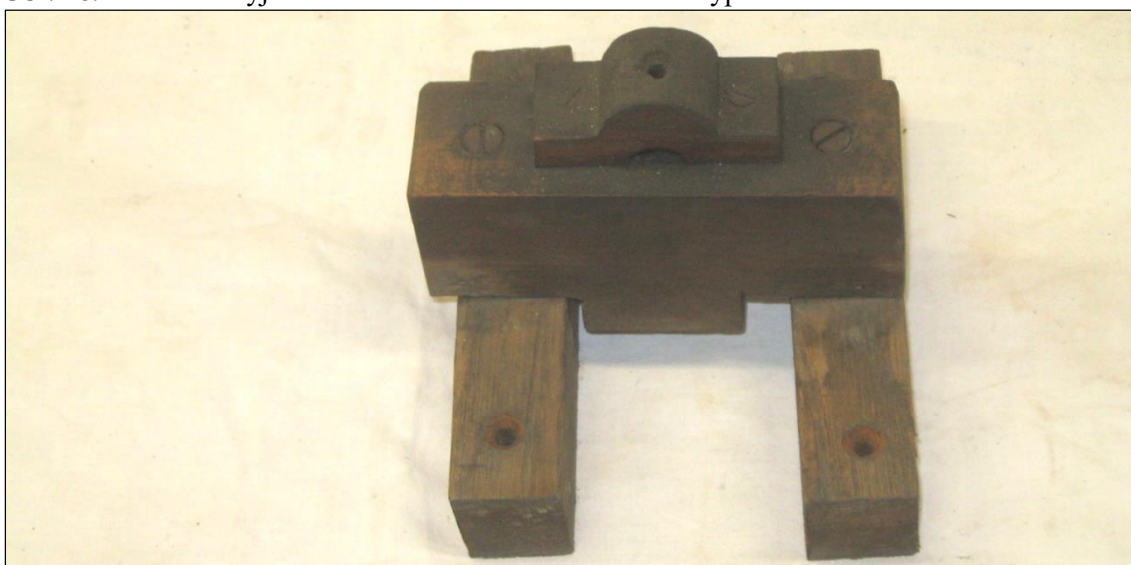
Obr. 17. Na snímku znečištěné shlaví se slavičkem a se spodními remlíky.
