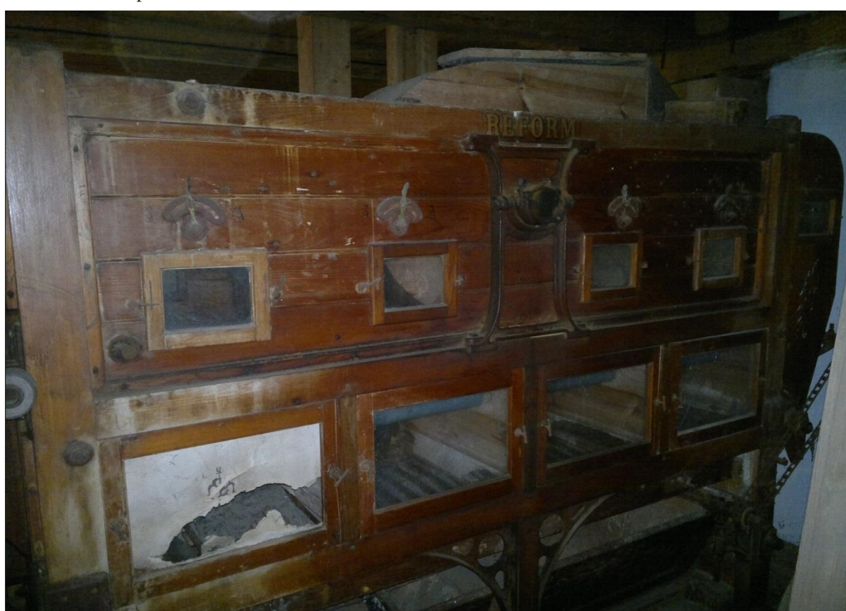
Obr. 11. Kopejtkův horní mlýn, Počátky čp. 339 (PE), reforma na čištění a třídění krupic i krupiček z počátku 20. stol. Foto D. Veverka, 2014.
