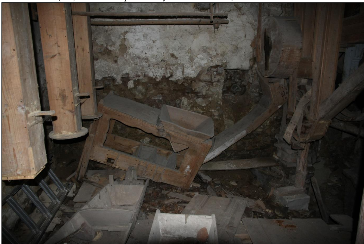
Obr. 37. Votice (BN). Podkolí. Zcela vlevo čtyři spádové trubky od moučného vysévače, malá štoska s tarárem a pata kapsového výtahu. Foto R. Šimek, 2014.
