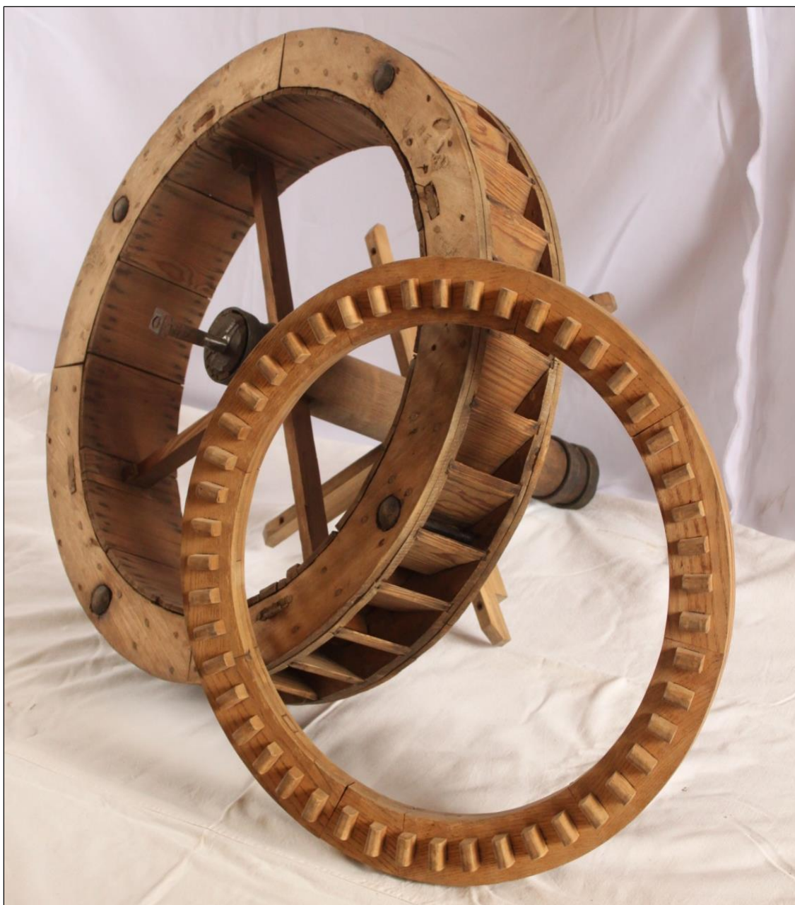
Obr. 31. Na snímku opravené vodní kolo a paleční kolo.
