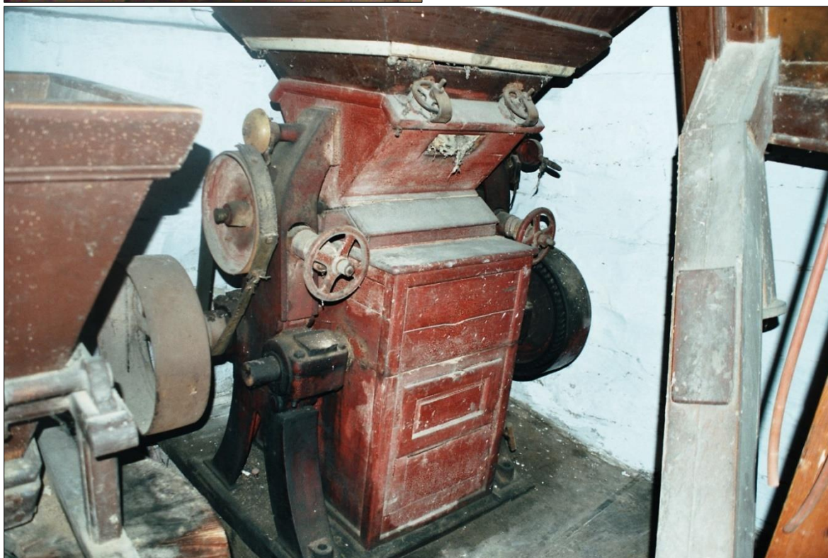
Obr. 3. Dolejší mlýn, Rozsedly čp. 14 (KT), válcová stolice výrobce B. Říha – Plzeň, kolem r. 1888. Foto D. Veverka, 2009.
