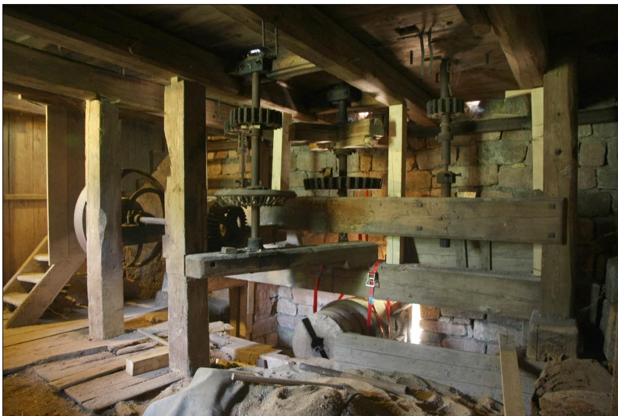
Obr. 2. Bradlecká Lhota (SE). Pohled na podkolí. Vertikální hřídel a transmise v popředí sloužily k pohonu válcové mlecí stolice. Foto R. Šimek, 2014.
