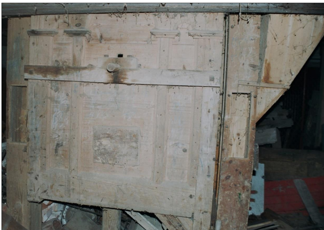
Obr. 14. Mlýn v Tedražicích u Sušice čp. 35 (KT), hranolový vysévač na třídění mlýnských produktů přestavěný na konci 19. stol. z moučnice, jedná se o tzv. poloumělecké složení, výroba řemeslná. Foto D. Veverka, 2010.
