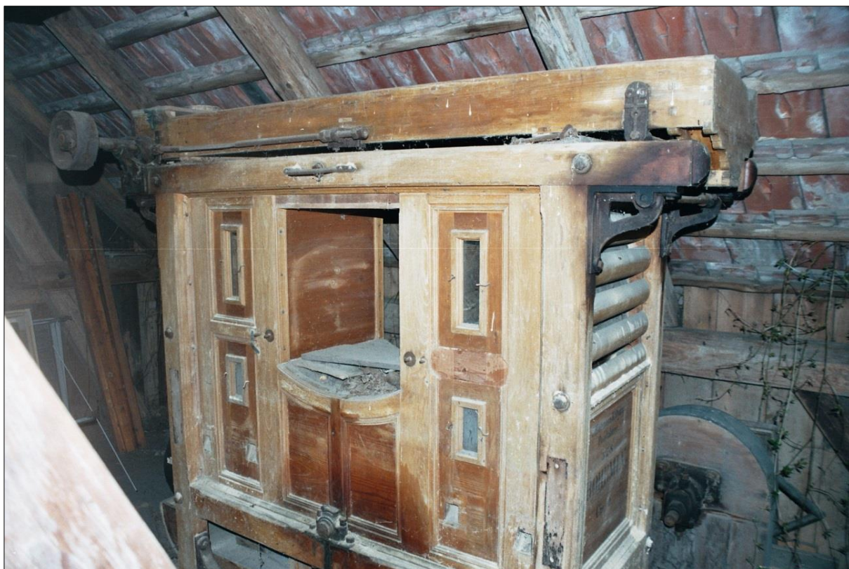
Obr. 10. Mlýn Javorníček čp. 8 (UO), ssavka na čištění a třídění krupic i krupiček od firmy J. Hübner a K. Opitz – Pardubice, kolem r. 1890. Foto D. Veverka, 2008.
