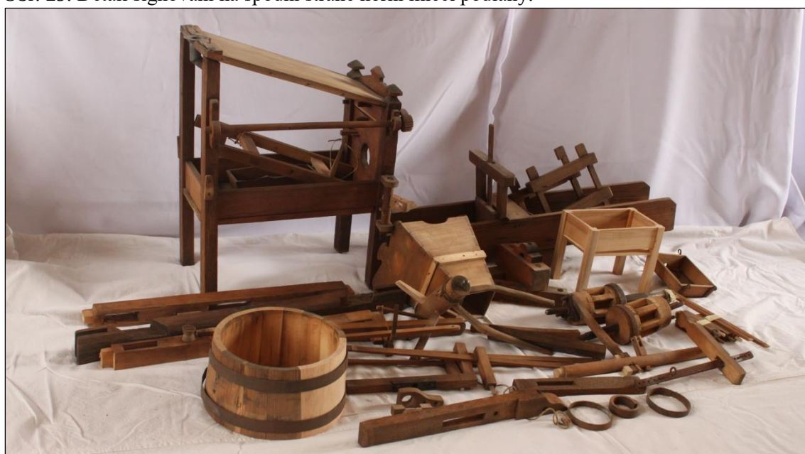
Obr. 30. Na snímku opravené a doplněné části. V popředí doplněný lub mlecího kamene.
