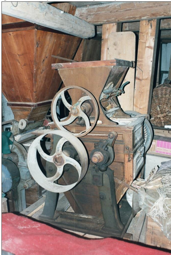
Obr. 1. Mlýn Javorníček čp. 8 (UO), válcová mlecí stolice s rýhovanými válci od výrobce Josef Prokop Vdova – Pardubice, kolem r. 1888. Foto D. Veverka, 2008.
