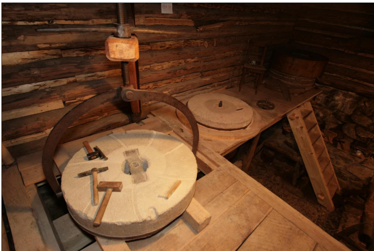
Obr. 6. Kres kameňov. Pre získanie kvalitných produktov je potrebné opatriť mlecie plochy kameňov vhodným systémom drážok. Foto M. Petráš, 2013.
