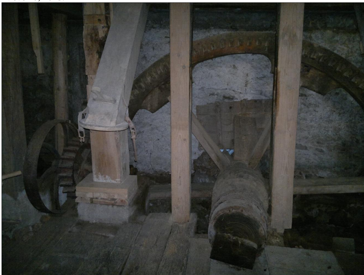
Obr. 19. Kopejtkův horní mlýn, Počátky čp. 339 (PE), paleční převod. Foto D. Veverka, 2014.
