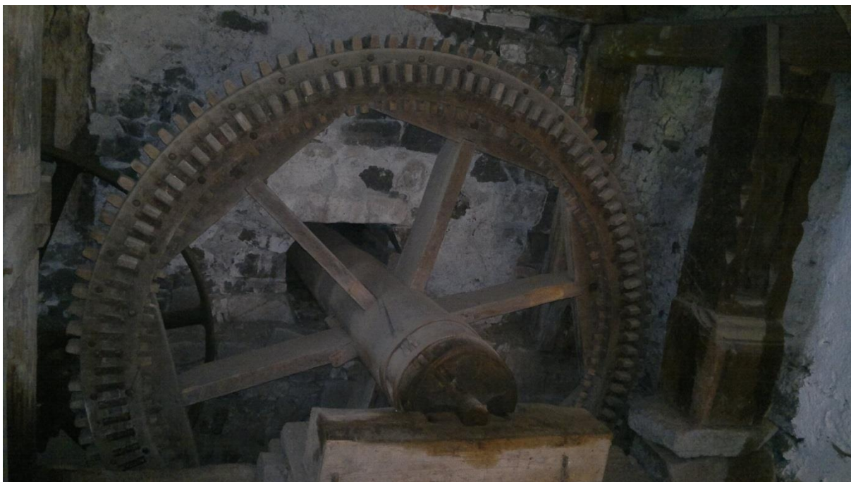
Obr. 22. Mlýn Leštinka čp. 4 (CR), paleční kolo s čelními i bočními palci řemeslné výroby. Foto D. Veverka, 2011.
