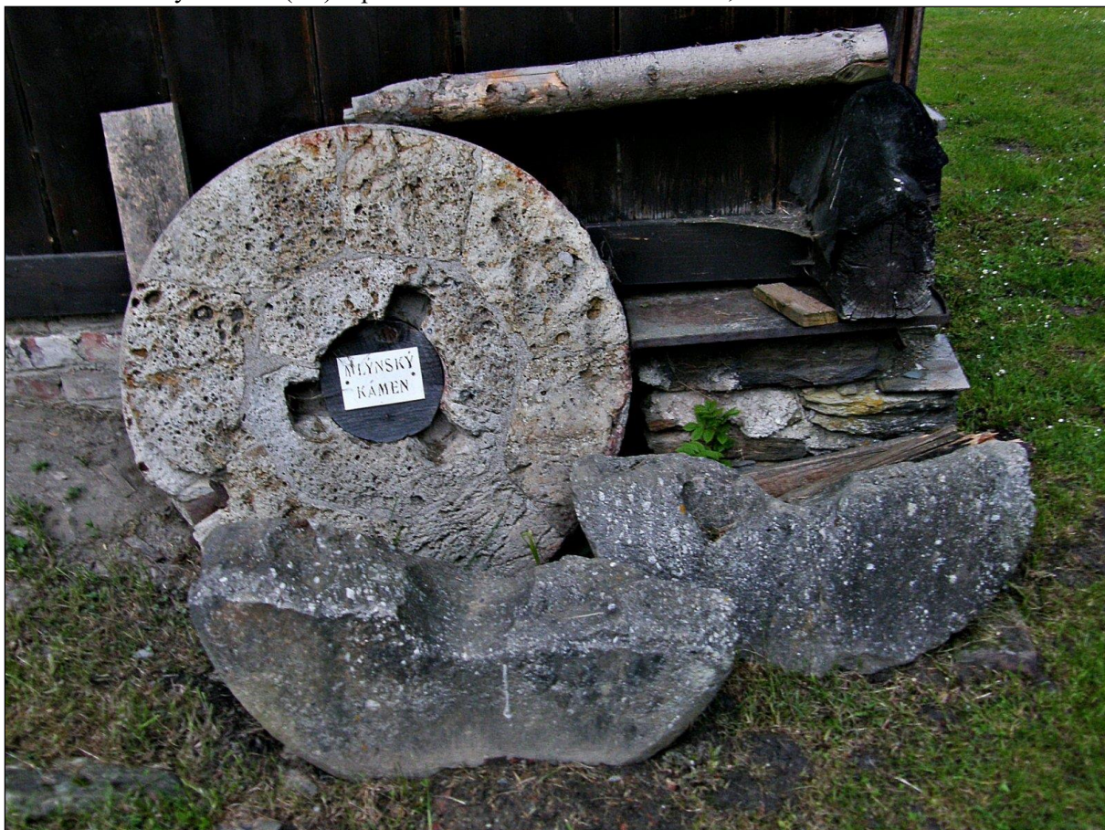
Obr. 12. Roztoky u Semil (SE). Francouzský mlecí kámen využívaný pravděpodobně před osazením válcové stolice. Foto P. Špráchal, 2014.
